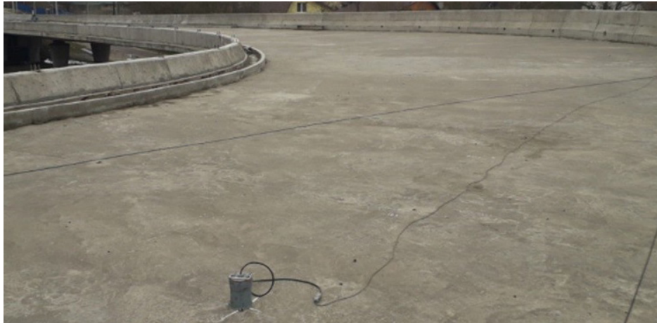
Рисунок 4 – Сейсмоприймач ОСП-2МВ на проїзній частині у прогоні 6-7
