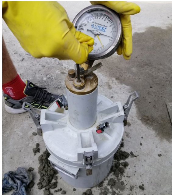
Рисунок 1 – Визначення кількості залученого повітря з використанням пороміру UTC-0650
