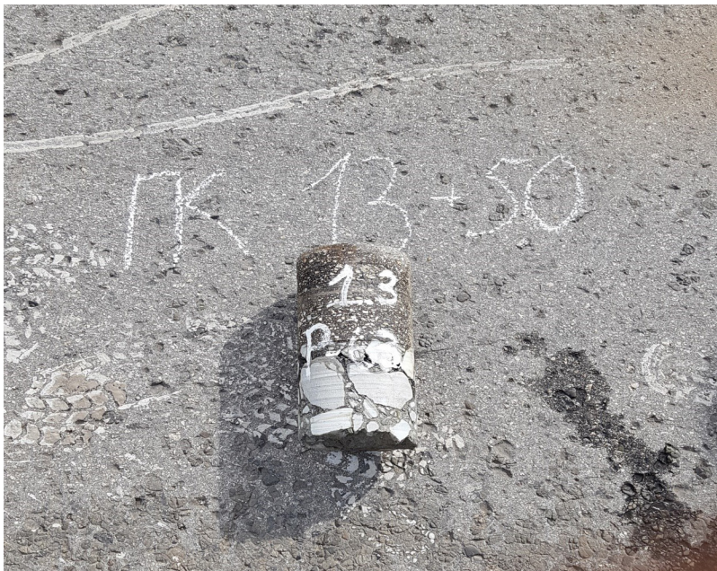
Рисунок 3 – Відібраний керни з дорожнього одягу для лабораторного аналізу
