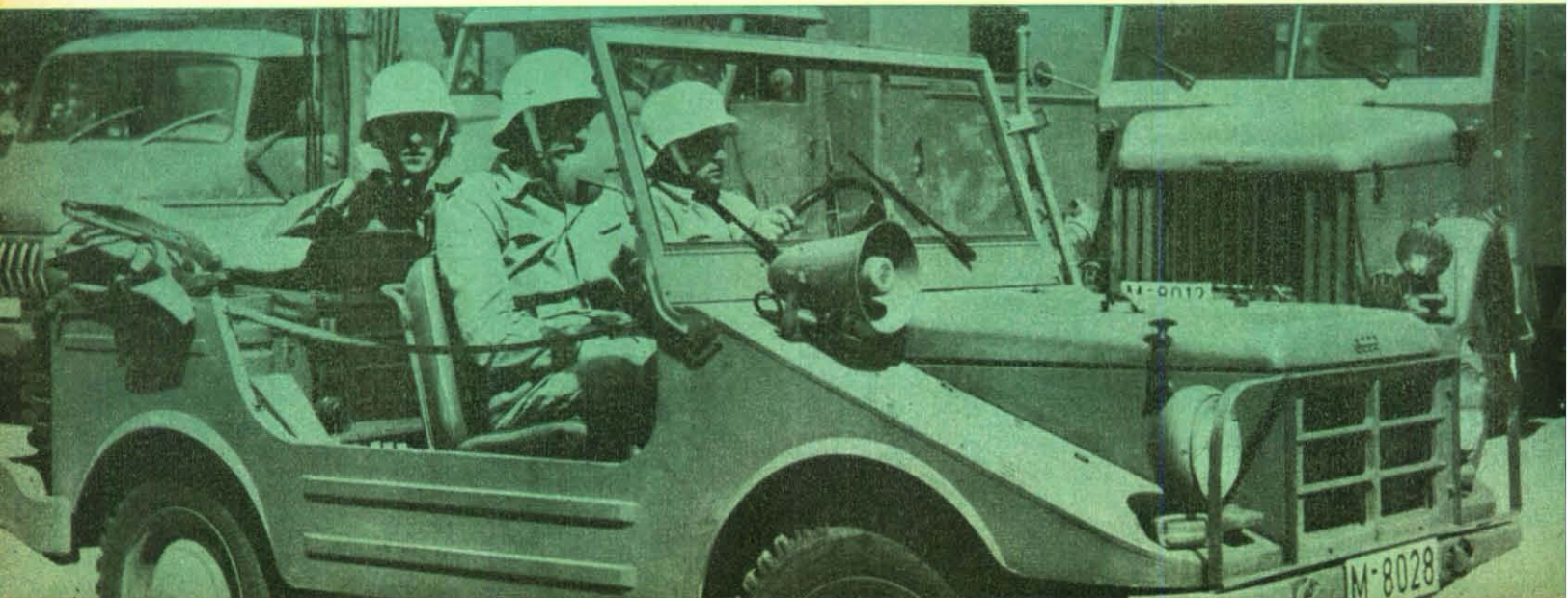
Funkkommandowagen mit Bereitschaftsführer, Kraftfahrer und Fernmelder. - Die moderne Antennenanlage am „Heck“ des Fahrzeuges kann teleskopartig ausgefahren werden. Mit ihrer Hilfe sind drahtlose Verbindungen auch über weite Entfernungen noch möglich.
