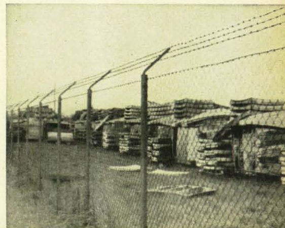
Gewappnet sein ist alles! Dieses Vorratslager der dänischen Zivilverteidigung bei Kopenhagen enthält vorgefertigte Betonelemente und Norm-Holzformen für den Schutzraumbau.
