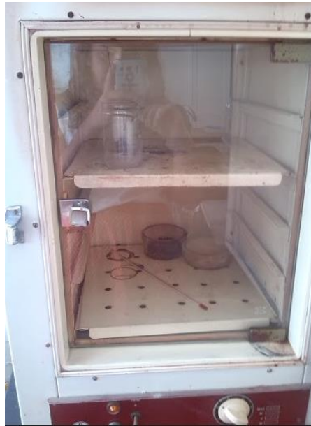
Figura 8: Estufa utilizada para la incubación, en las concentraciones de etanol indicadas, de los trozos de hígado de cerdo durante 18 minutos. Se pueden apreciar los vasos de precipitado que contienen los trozos de hígado en las disoluciones de alcohol.
