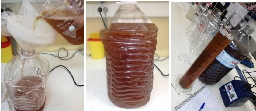
Εικόνα 62. Μετάγγιση και απολάσπωση του γλεύκους μετά την απόψυξη (α-γ).
