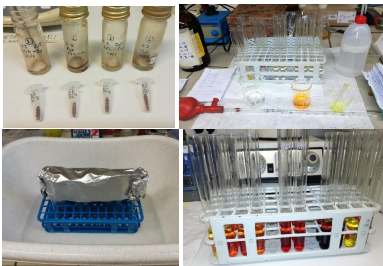
Εικόνα 54. (α-δ) Προσδιορισμός Ενδοπολυσακχαριτών – DNS.
