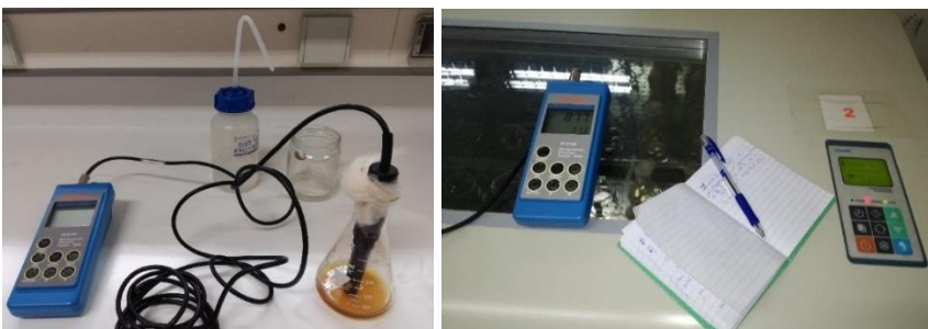
Εικόνα 50. α) β) Μέτρηση διαλυτού οξυγόνου με ηλεκτρόδιο Hanna Instruments.
