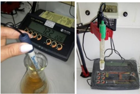
Εικόνα 49. α) Προσδιορισμός pH β) pH-μετρο τύπου HI-2211 by Hanna Instruments.
