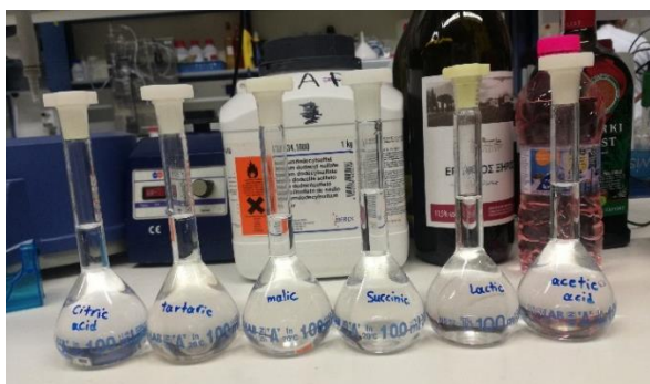
Εικόνα 57. Τα κυριότερα οξέα του οίνου σε διαφορετικές συγκεντρώσεις. Κιτρικό (RT=11), τρυγικό (11,8), μηλικό (13), ηλεκτρικό (15), L-Γαλακτικό οξύ (16,8) και οξικό οξύ (18,7-19).
