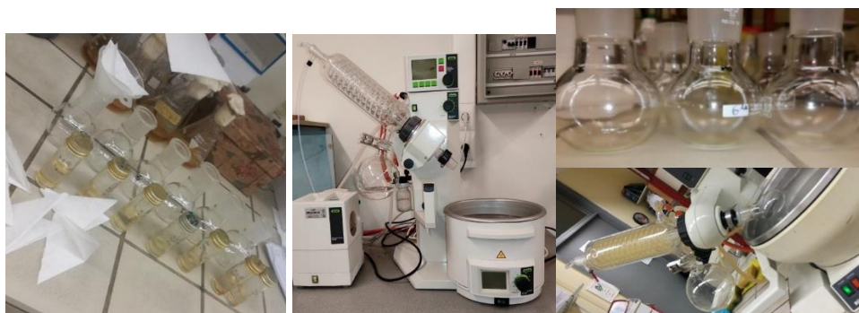
Εικόνες 55. (α-δ) Προσδιορισμός μικροβιακού λίπους, με περιστροφικό εξατμιστήρα.
