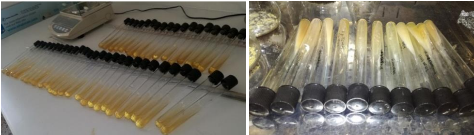
Εικόνες 42. α) (Αριστερά) Δημιουργία Slants, β) (Δεξιά) Τοποθέτηση εμβολιασμένων Slants σε επωαστή (θ ≈ 30°C) προς ανάπτυξη των μικροοργανισμών.
