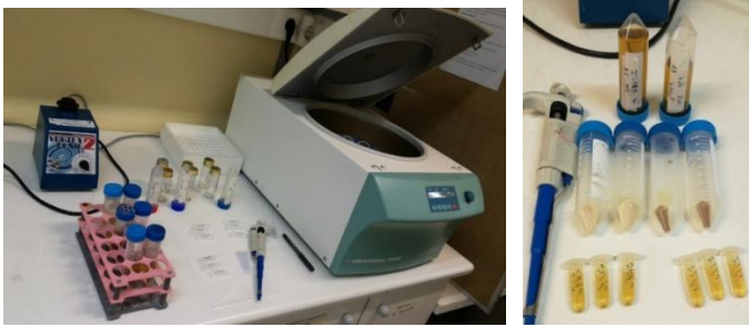
Εικόνα 47. α) Διαδικασία παραλαβής Σημείου με την πρώτη φυγοκέντρηση, όπου πραγματοποιείται διαχωρισμός ιζήματος β) (φαίνεται μέσα στα falcons) και υπερκείμενου υγρού που μεταφέρεται σε erpendorfs των 2ml προς ανάλυση HPLC.
