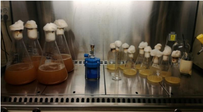
Εικόνα 68. Διαδοχικός (δεύτερος) εμβολιασμός με υγρή προκαλλιέργεια S.c. rhone του εν ζυμώσει παστεριωμένου γλεύκους υπό ασηπτικές συνθήκες.
