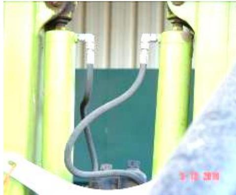
O seguinte exemplo mostra mais um caso em que a alfaia está equipada com uma válvula direccional que o operador actuará para fornecer fluxo de óleo alternadamente para um actuador, ou para o outro, sempre **de uma única válvula do SESH do tractor:**
