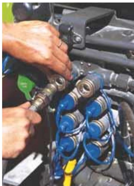
Às tomadas ligam-se os acoplamentos macho que estão na extremidade das mangueiras da alfaia. O conjunto formado pelo acoplamento macho/fêmea (*Quick-acting hydraulic couplings*) permitem a passagem de óleo em ambos os sentidos. Ao serem separados não haverá fuga de óleo do sistema, uma vez que cada um tem uma válvula de retenção.
