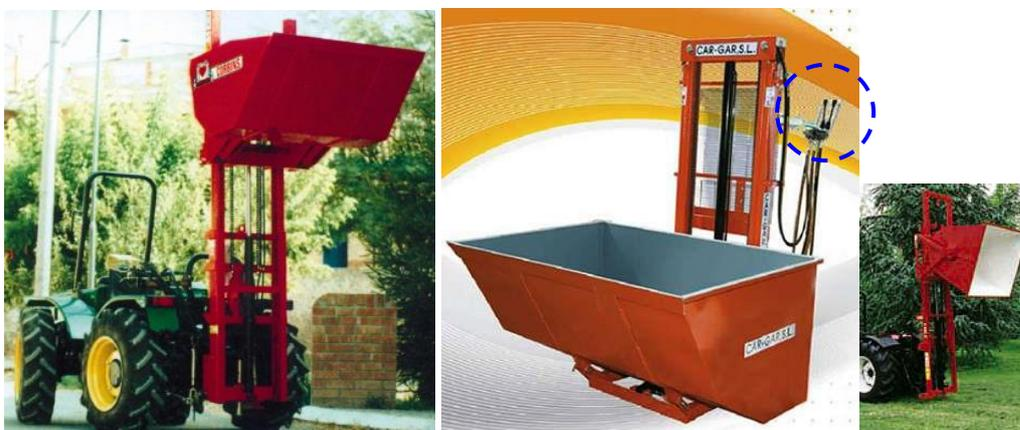
O construtor do equipamento coloca na própria alfaia o conjunto de válvulas que distribuem óleo para os diversos actuadores.
