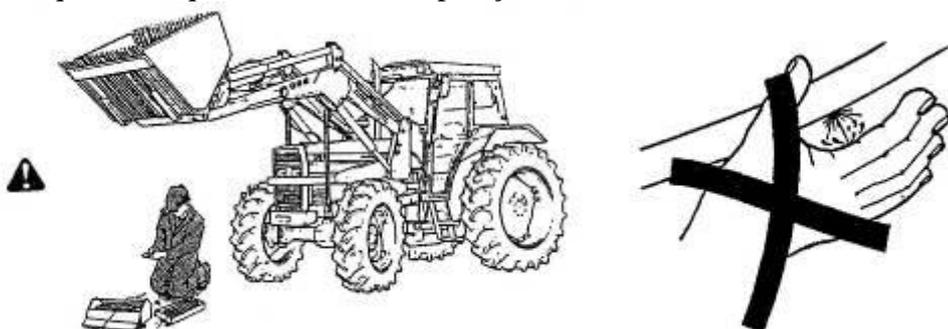
O óleo do sistema hidráulico, sob pressão, pode penetrar na pele ou nos olhos, causando sérios danos físicos e cegueira. A fuga de um fluído sob pressão pode não ser visível, pelo que em caso de inspecção, utilize um pedaço de cartão ou de madeira e nunca a mão. Se qualquer fluído penetrar a pele, deverá procurar de imediato ajuda médica.
