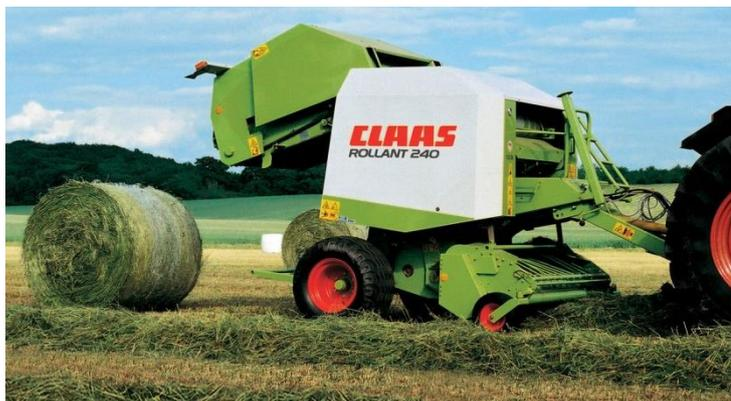
Exemplo: Na abertura e fecho da tampa da enfardadeira da figura anterior o operador actua a alavanca da válvula do SESH para a posição de levantar ou baixar, respectivamente, e retirar a mão. Assim que o levantamento ou o fecho tiver terminado a alavanca retorna ao neutro automaticamente.
