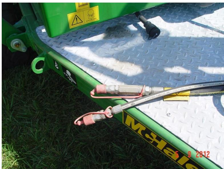
Uma mangueira leva o óleo do tractor para o conjunto das válvulas e a outra traz o óleo de volta para o tractor. Do SESH requer-se apenas uma válvula de actuação de um cilindro de duplo efeito, com detenção (para caudal contínuo) e retorno de baixa pressão.
