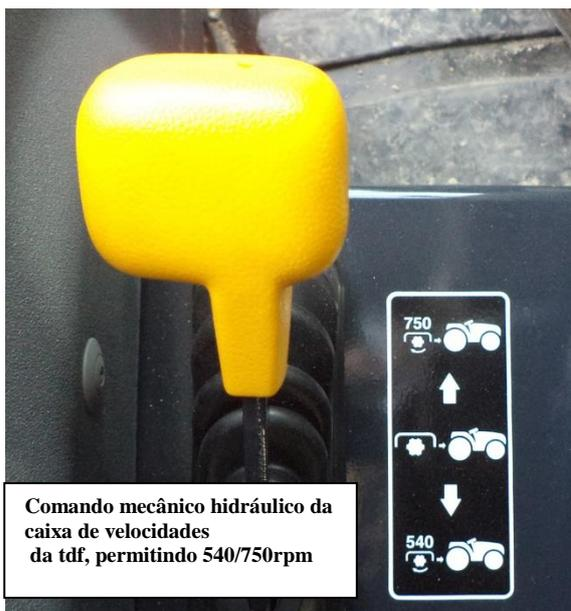
Comando mecânico hidráulico da caixa de velocidades da tdf, permitindo 540/750rpm
