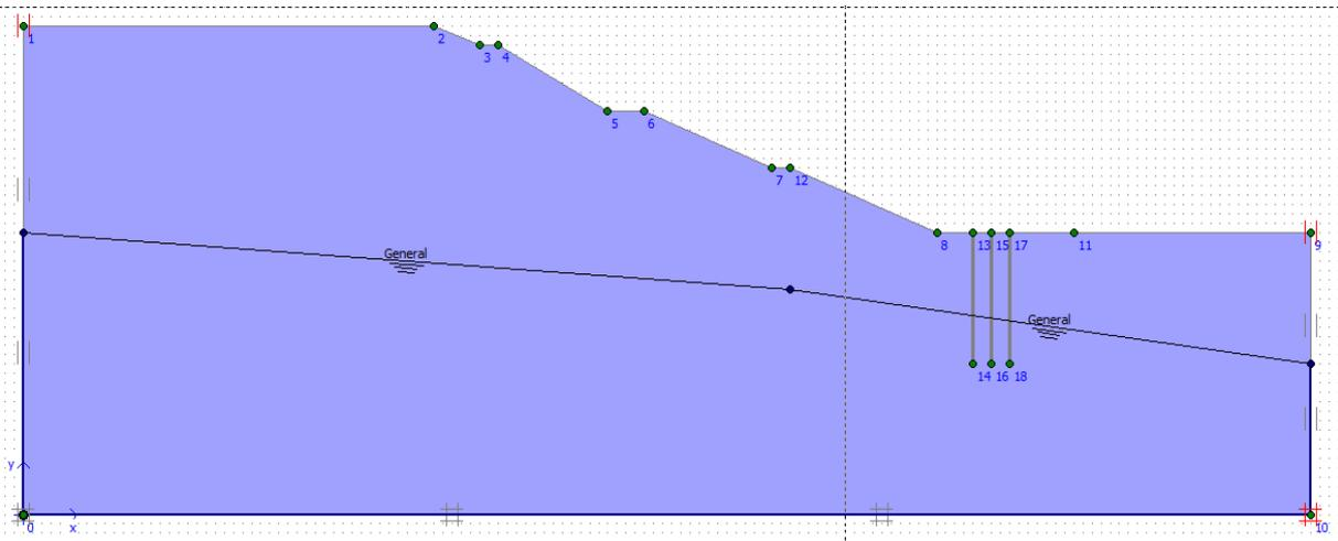
**Figure V.17 :** niveau de la nappe pour un sol avec renforcement
