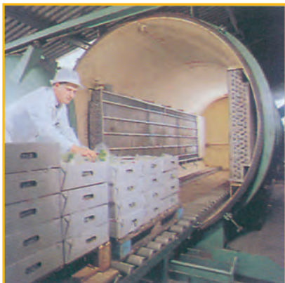
Εικόνα 2.13 Πρόψυξη με κενό
