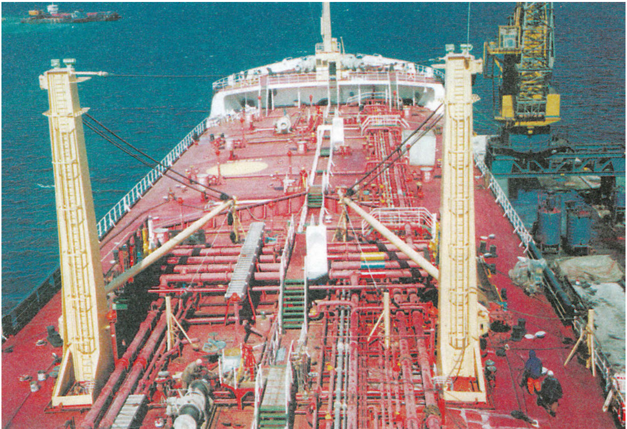
Φωτογραφία 1.3: Πανοραμική άποψη του καταστρώματος ενός δεξαμενοπλοίου (tanker)
