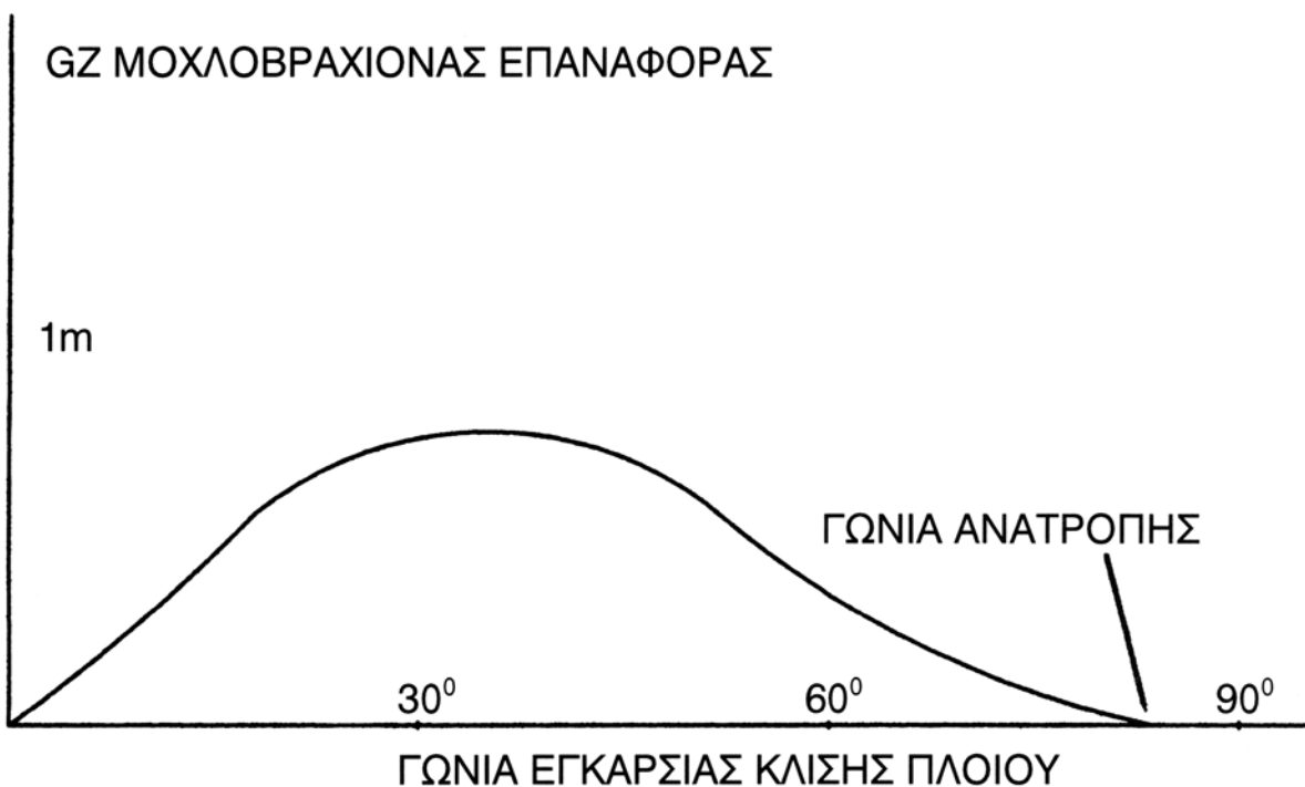
Σχ. 13.4 Καμπύλη μοχλοβραχίονα επαναφοράς
