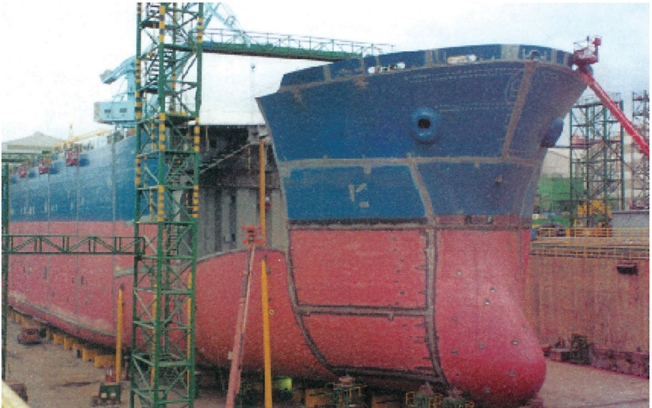
Φωτ. 9.5 Τοποθέτηση προραίου block
