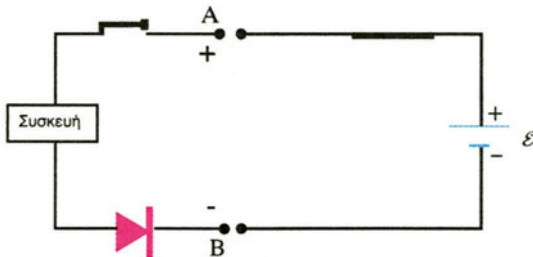
Η δίοδος προστατεύει τη συσκευή από λανθασμένη σύνδεση. Εικόνα 2.11-56.
