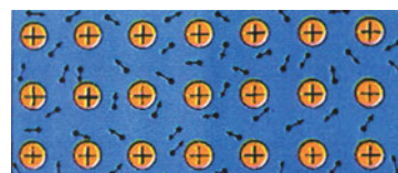
Εσωτερικό μεταλλικού αγωγού.
