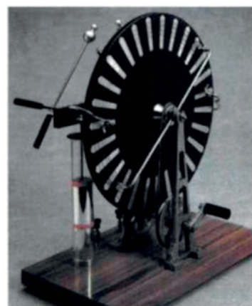
Μηχανή Wimshurst. Εικόνα 1.5-51.
