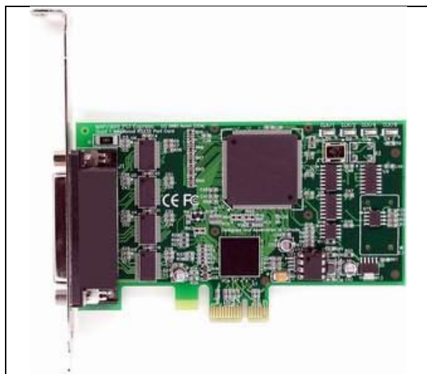
Karta určená do sběrnice PCI Express \times 1 , kterou je však možné zapojit i do všech širších konektorů PCI Express – \times 2 , \times 4 , \times 8 i \times 16
