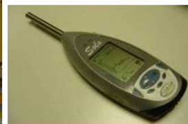
Σταθμός 24ωρης καταγραφής Ο.Κ.Θ. & θορύβου εργοταξίων SOLO Premium σε ιστό 4,0μ βάσει Ευρωπαϊκής οδηγίας
