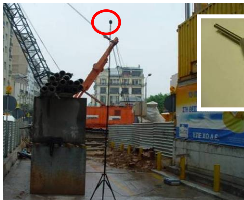
Σταθμός 24ωρης καταγραφής Ο.Κ.Θ. & θορύβου εργοταξίων SOLO Premium σε ιστό 4,0μ βάσει Ευρωπαϊκής οδηγίας
