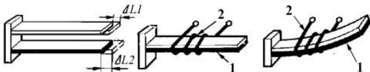
Рис.13. Принцип работы биметаллических реле: 1 – биметаллическая пластина; 2 – нагревательный элемент [3].
