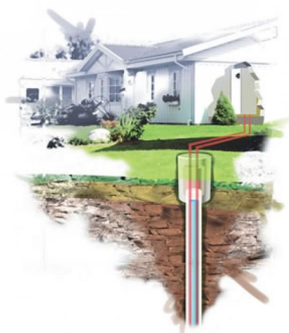
Obr. 8.15: Aplikace tepelného čerpadla, systém země voda. [63]
