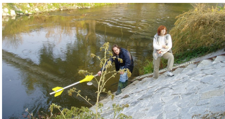
Obr. 31 Torpédo na hydrometrické lanovce na profilu Ústí n. L. – řeka Bílina
