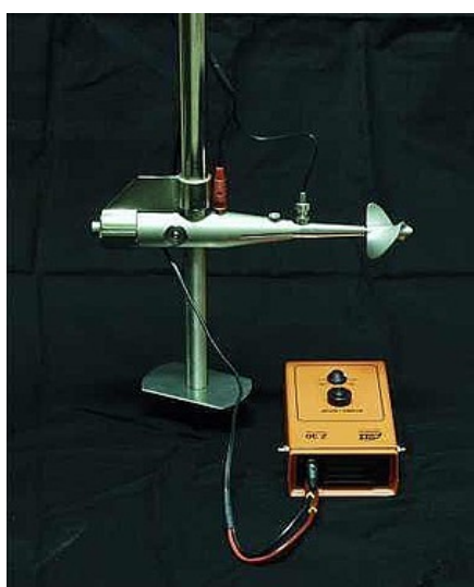
Obr. 30 Vrtule a způsob měření (ČHMÚ Ústí n. L.)
