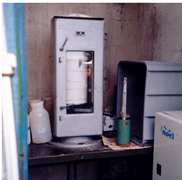
Obr. 29 Plovákový limnigraf na profilu ČHMÚ v Ústí n. L. na řece Bílině
