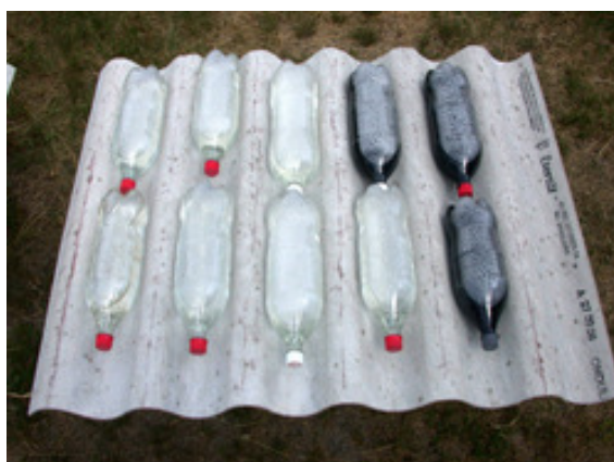
Figura 2: PETs claras e com um dos lados pintados de preto para absorver melhor a luz solar. Fonte: FAPERJ, 2007.
