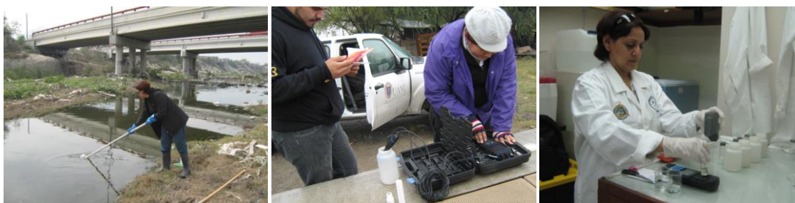
Figura 16. a) Izquierda, toma de muestra de agua; b) centro, análisis in situ de parámetros físicoquímicos; c) derecha, análisis de arsénico, cianuro, turbiedad y nitratos.
