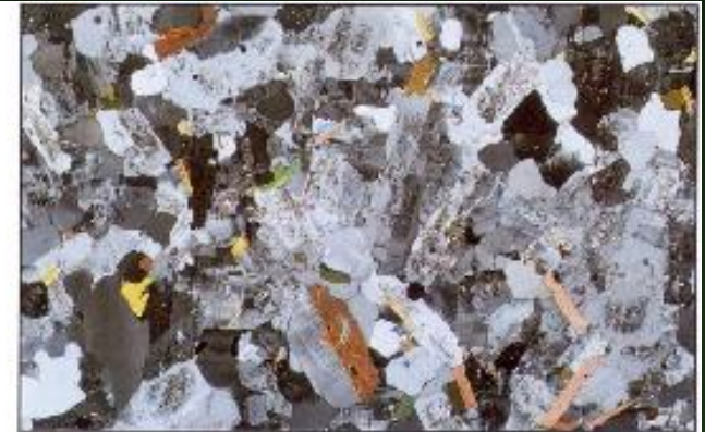
Vzorek žuly pozorovaný při zkřížených nikolech
