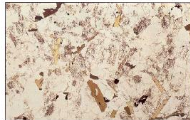
Vzorek žuly pozorovaný při rovnoběžných nikolech
