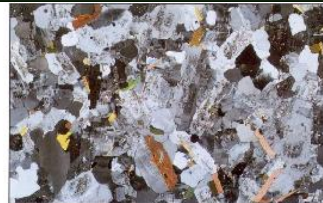
Vzorek žuly pozorovaný při zkřížených nikolech
