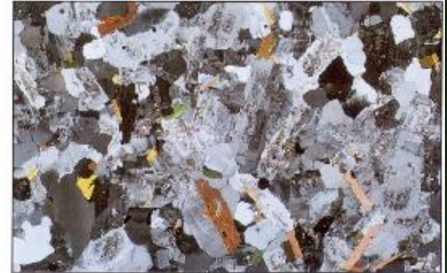
Vzorek žuly pozorovaný při zkřížených nikolech
