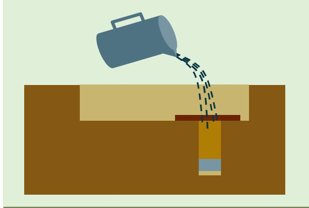
La Medición de la tasa de filtración se hará pasado el período de saturación, indicado en el punto anterior, se ajusta la profundidad del agua a por lo menos 15 centímetros sobre la grava o arena gruesa colocada en el fondo.
