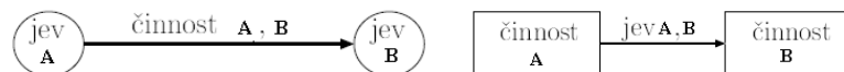
Obrázek 1.1: Vlevo je ukázka hranově orientovaného grafu a vpravo je zobrazen uzlově orientovaný graf.
