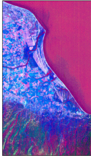
Εικόνα 4.291. Τμήμα της εικόνας Hyperion μετά το μετασχηματισμό MNF. Η χρωματική εμφάνιση της εικόνας προέκυψε από το συνδυασμό διαύλων: R=MNF5, G=MNF3, B=MNF1.
