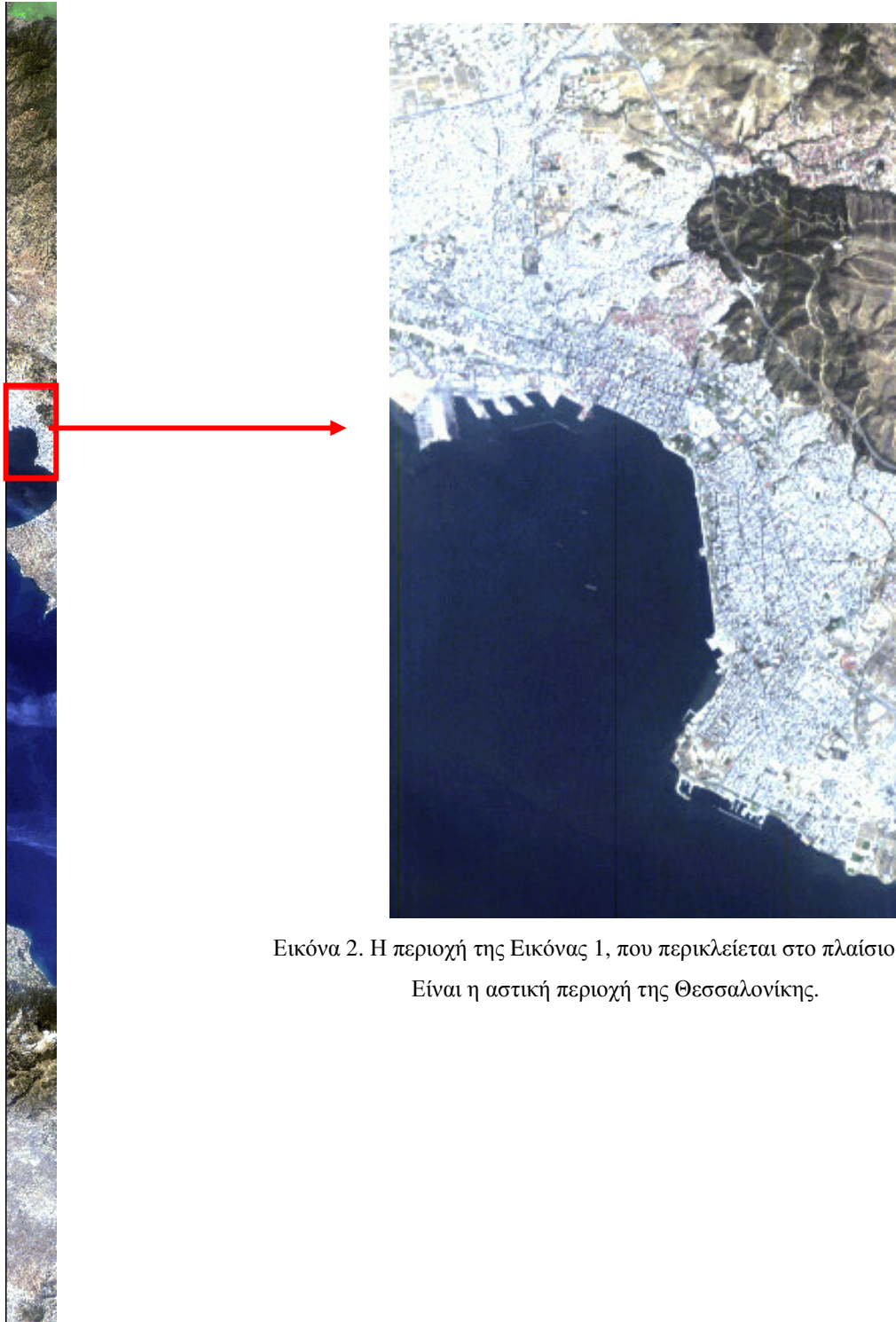
Εικόνα 1. Η εικόνα Hyperion της παρούσας μεταπτυχιακής διπλωματικής εργασίας. Η χρωματική εμφάνιση της εικόνας πρόέκυψε από το συνδυασμό των διαύλων: R=25, G=20, B=11.
