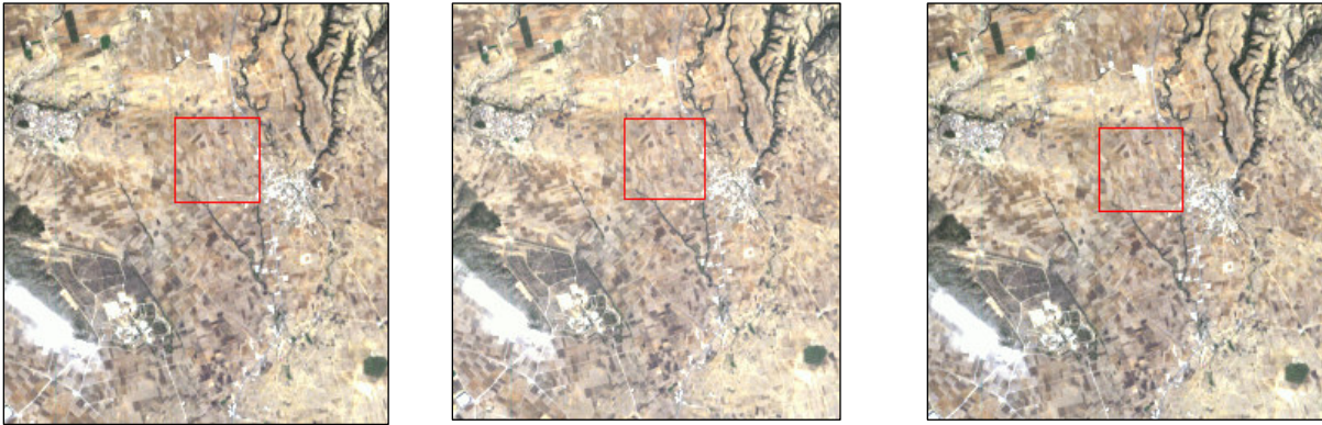
Εικόνες 4.204-4.206. Περιοχή της εικόνας Hyperion πριν (αριστερά) και μετά την ατμοσφαιρική διόρθωση με τον αλγόριθμο IARR (ERDAS IMAGINE 9.0) (κέντρο) και στο ENVI 4.3 (δεξιά).
