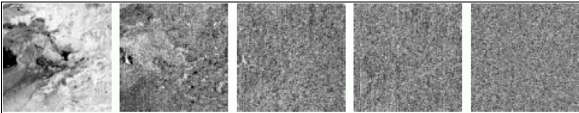
Εικόνα 1.21. Εικόνες MNF των δεδομένων Hyperion (περιοχή μελέτης βόρεια Death Valley). Από αριστερά προς δεξιά παρουσιάζεται ο διάυλος MNF 1, MNF 5, MNF 8, MNF 10 και MNF 20. Παρατηρείται ότι οι αρχικοί διάυλοι MNF 1, MNF 5 περιέχουν τη χρήσιμη πληροφορία. Οι διάυλοι MNF 8, MNF 10 και MNF 20 περιέχουν κυρίως θόρυβο, [21].
