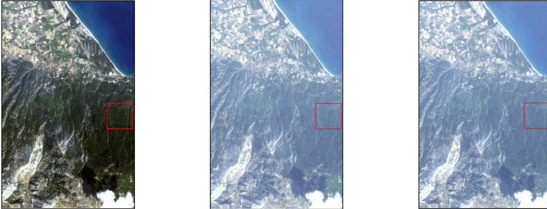
Εικόνες 4.108-4.110. Ορεινή περιοχή της εικόνας Hyperion πριν (αριστερά) και μετά την ατμοσφαιρική διόρθωση με τη χρήση της μεθόδου “2-Band (K-T)” (κέντρο) και της αρχικής τιμής ορατότητας της εικόνας (δεξιά).
