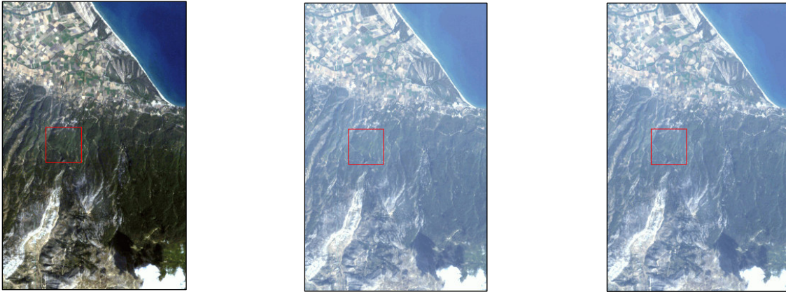
Εικόνες 4.102-4.104. Ορεινή περιοχή της εικόνας Hyperion πριν (αριστερά) και μετά την ατμοσφαιρική διόρθωση με τη χρήση της μεθόδου “2-Band (K-T)” (κέντρο) και της αρχικής τιμής ορατότητας της εικόνας (δεξιά).
