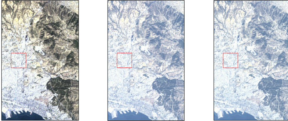
Εικόνες 4.126-4.128. Αστική περιοχή της εικόνας Hyregion πριν (αριστερά) και μετά την ατμοσφαιρική διόρθωσή της (κέντρο και δεξιά). Κατά την εφαρμογή της ατμοσφαιρικής διόρθωσης χρησιμοποιήθηκε το αστικό μοντέλο (urban) (στο κέντρο) και το αγροτικό (rural) (δεξιά).
