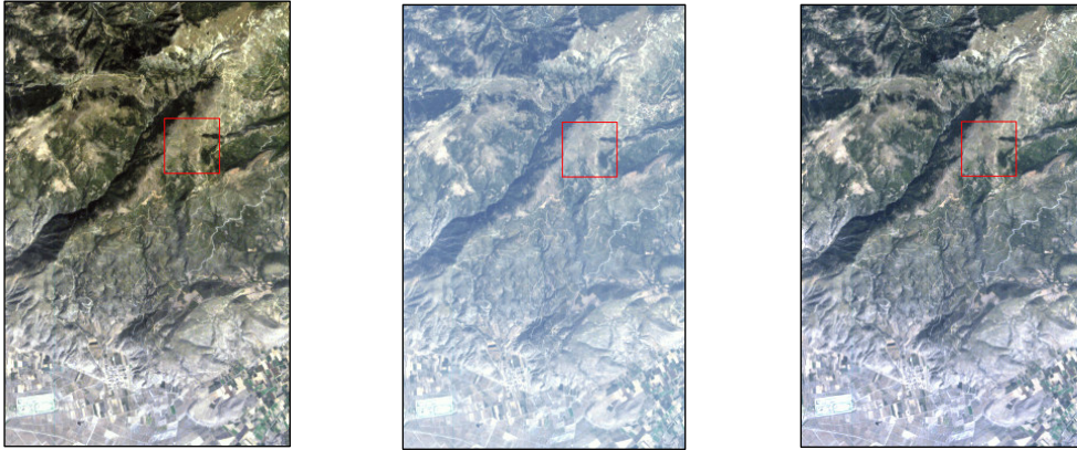
Εικόνες 4.178-4.180. Περιοχή της εικόνας Hydreion πριν (αριστερά), μετά την ατμοσφαιρική διόρθωση ολόκληρης της εικόνας (κέντρο) και των ξεχωριστών τμημάτων της (δεξιά).
