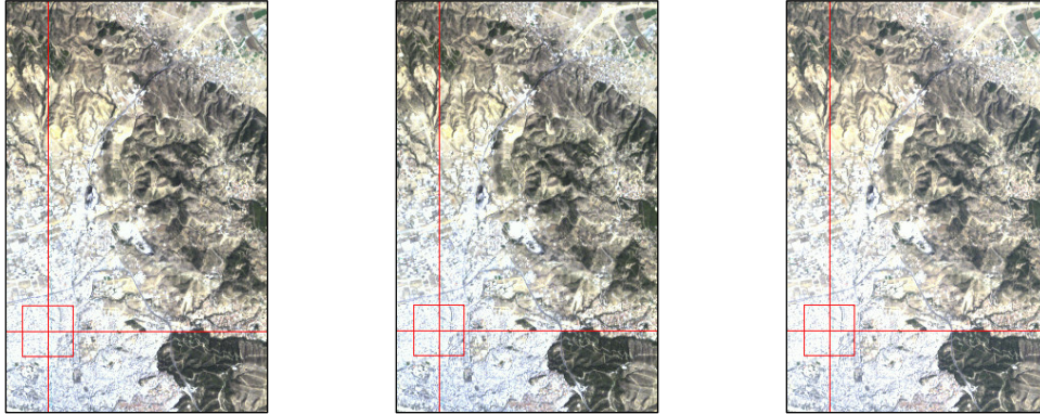
Εικόνες 4.218-4.220. Περιοχή της εικόνας Hygeion πριν (αριστερά) και μετά την ατμοσφαιρική διόρθωση με τον αλγόριθμο IARR (ERDAS IMAGINE 9.0) (κέντρο) και στο ENVI 4.3 (δεξιά).
