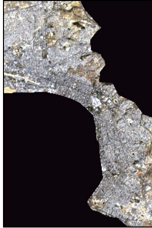
Εικόνα 4.184. Αστική περιοχή της εικόνας Hyperion. Η χρωματική εμφάνιση της εικόνας προέκυψε από το συνδυασμό διαύλων: R=30 (651,995nm), G=23 (580,89nm), B=14 (489,488nm).
