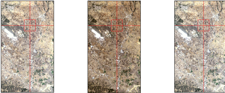
Εικόνες 4.225-4.227. Περιοχή της εικόνας Hyperion πριν (αριστερά) και μετά την ατμοσφαιρική διόρθωση με τον αλγόριθμο Empirical Line (ERDAS IMAGINE 9.0) (κέντρο) και στο ENVI 4.3 (δεξιά).
