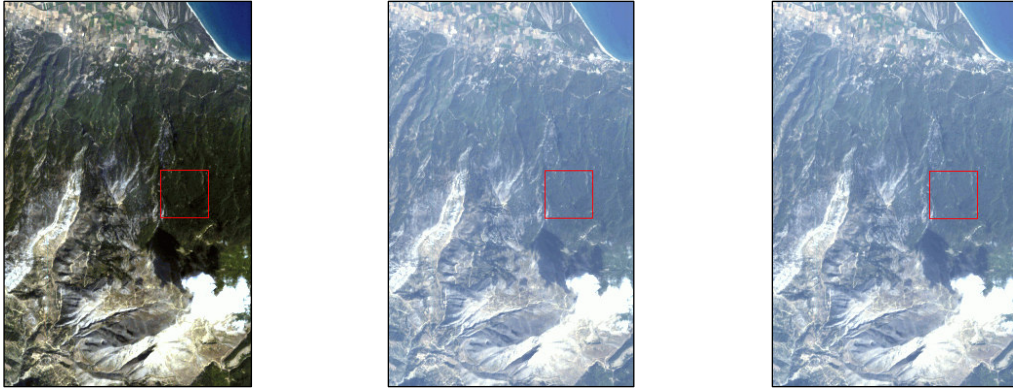
Εικόνες 4.150-4.152. Περιοχή της εικόνας Hyperion πριν (αριστερά) και μετά την ατμοσφαιρική διόρθωσή της (κέντρο/χωρίς τη χρήση “spectral polishing” και δεξιά/με τη χρήση “spectral polishing”).
