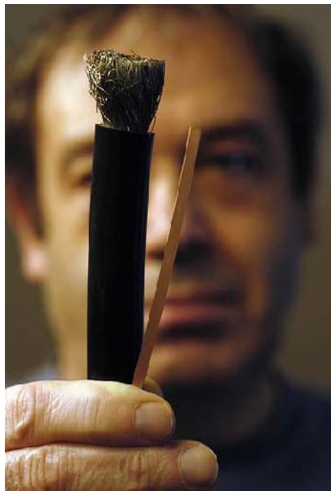
Σχήμα 3.85 Σύγκριση συμβατικού καλωδίου των 400 Amperes (αριστερά) και ενός υπεραγώγιμου τμήματος καλωδίου δεύτερης γενιάς (second-generation) στα 400 Amperes (δεξιά) (Rockwell Automations Cleveland lab)
