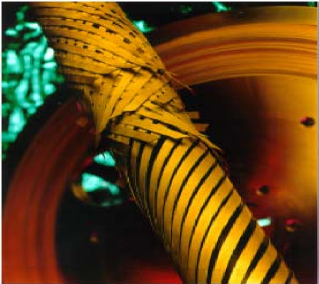
Σχήμα 3.33 Τέσσερα στρώματα ελικοειδούς ταινίας, διαμέτρου 1inch, δηλ. 2.53cm (Pirelli Cable USA)
