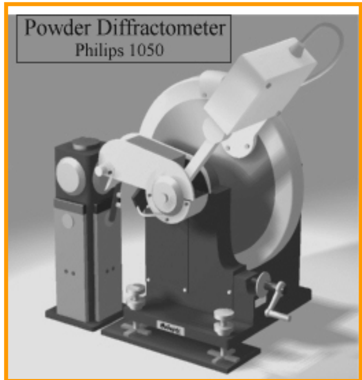
Σχήμα 2.5 Παλιό περιθλασίμετρο σκόνης γεωμετρίας \theta - 2\theta , με οριζόντιο άξονα στροφής (Philips PW1050. Εργ. Εφαρμ. Φυσικής, Τμήματος Φυσικής Α.Π.Θ.)
