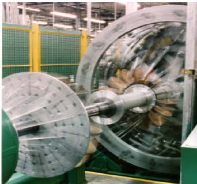
Σχήμα 3.34. Καλώδιο αγωγού που χρησιμοποιεί Bi-2223 OPIT/Ag καλώδιο ταινίας (Pirelli Cable USA)
