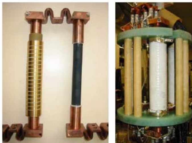
Σχήμα 3.57 FCL σε μορφή συνδέσεων στο δίκτυο ηλεκτρικής τάσης
