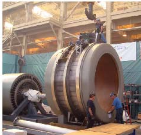
Σχήμα 3.80 36.5MWatt Κινητήρας πλοίου (ship propulsion motor, US Navy).
