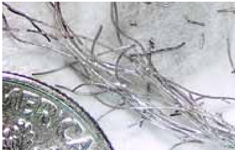
Σχήμα. 3.42 Υπεραγωγίμα καλώδια diboride μαγνήσιου MgB_2 , όπως εμφανίζονται μετά από την αφαίρεση από το σωλήνα τανταλίου.
