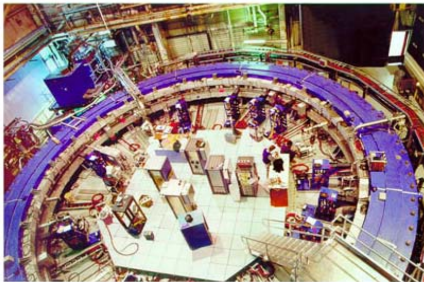
Σχήμα 3.4 Το πείραμα Muon g-2 Experiment χρησιμοποιεί το Alternating Gradient Synchrotron (AGS) μέσα στο μεγαλύτερο υπεραγωγίσιμο μαγνήτη του κόσμου, το έτος 2003, - που είναι και γνωστός ως, the "muon storage ring" -- (Η εικόνα από το U.S. Department of Energy's με τον τίτλο Brookhaven National Laboratory)
