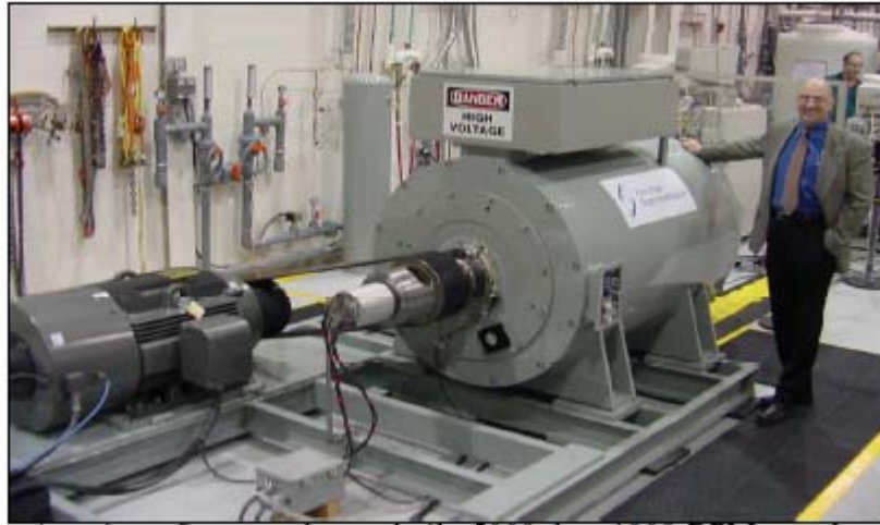
Σχήμα 3.84 Κινητήρας 5000hp,1800RPM, ελεγμένος για την λειτουργία του το 2001.
