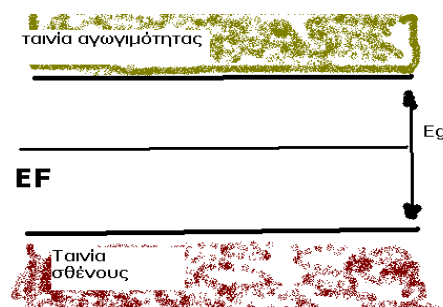
Σχήμα 1.30 Θέση της στάθμης E_F , Fermi, σε σχέση με το χάσμα και τις ταινίες αγωγιμότητας και σθένους
