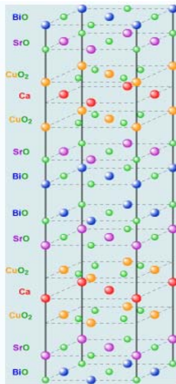
Σχήμα 3.49 BSCCO είναι η κατηγορία υλικών των high-temperature superconductors (HTS),
