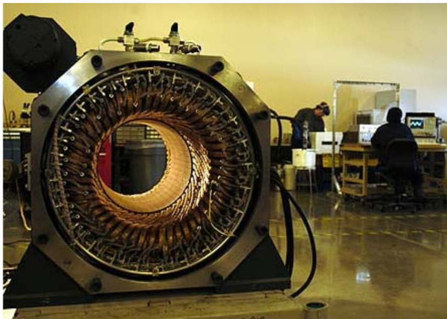
Σχήμα 3.82. 1000 ίππων ισχύος μηχανή, Υπεραγωγών, HTS (high-temperature superconductor motor, Rockwells Cleveland lab work)
