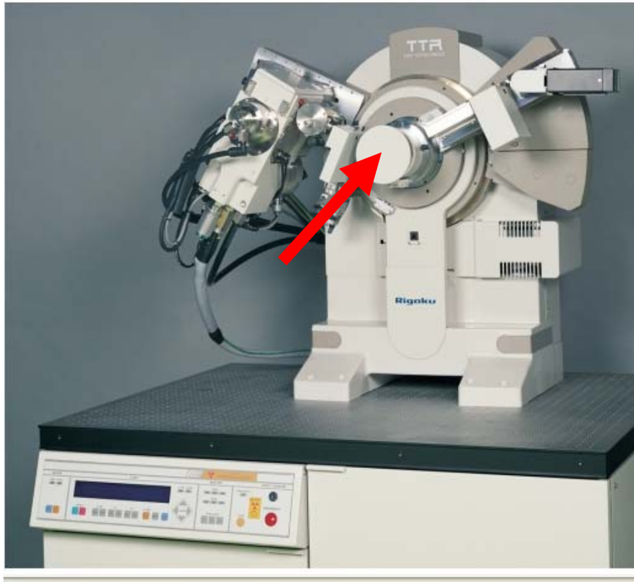
Σχήμα 2.6 Το νέο περιθλασίμετρο σκόνης, γεωμετρίας \theta - \theta (Rigaku) με οριζόντιο άξονα στροφής. [Εργαστήριο Εφαρμοσμένης Φυσικής, Φυσικού Τμήματος του Α.Π.Θ., 2007]
