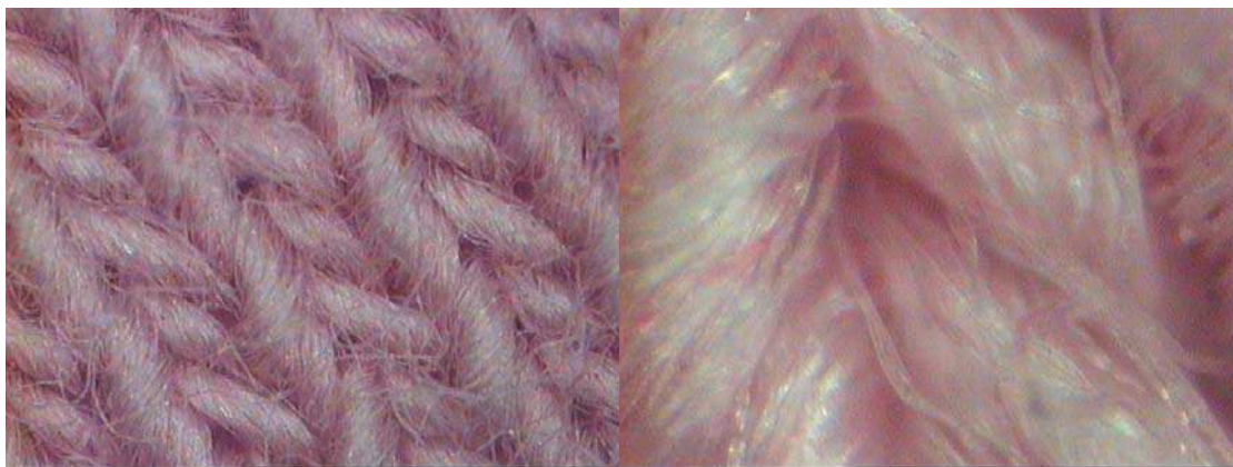
Εικόνα 44: Φωτογραφίες με οπτικό στερεοσκόπιο βαμβακερού βαμμένου με ριζάρι υφάσματος, x 25 και x100
