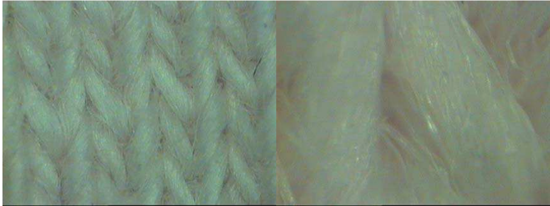
Εικόνα 43: Φωτογραφίες με οπτικό στερεοσκόπιο βαμβακερού υφάσματος, x 25 και x100
