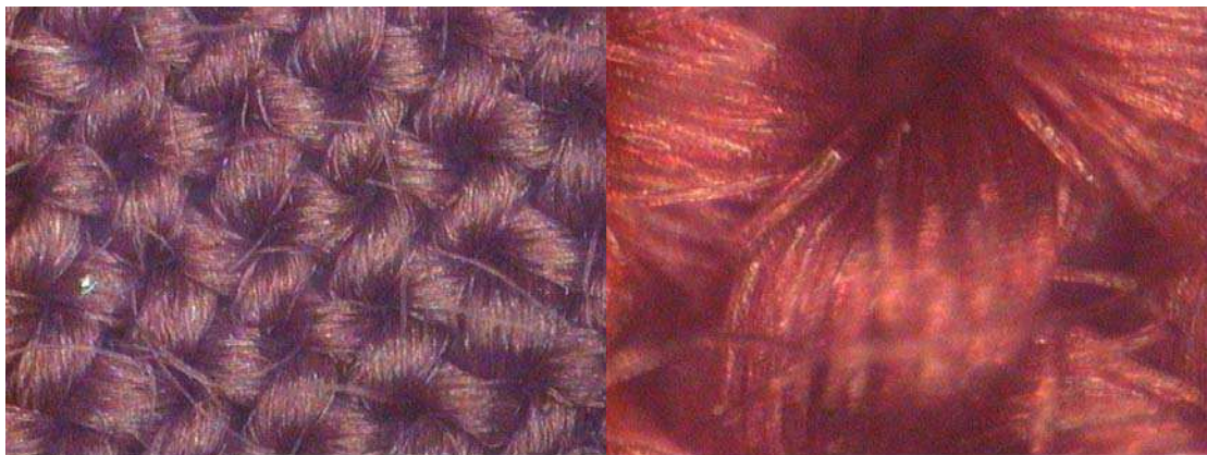
Εικόνα 42: Φωτογραφίες με οπτικό στερεοσκόπιο μάλλινου βαμμένου με ριζάρι υφάσματος, x 25 και x100
