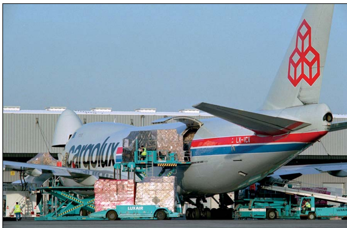
Σχήμα 3.40 Φόρτωση B747F από την πλευρική θύρα
