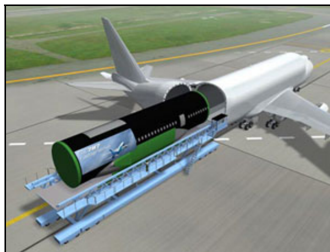
Σχήμα 3.37 Φόρτωση τμήματος ατράκτου B787 στο B747LCF
