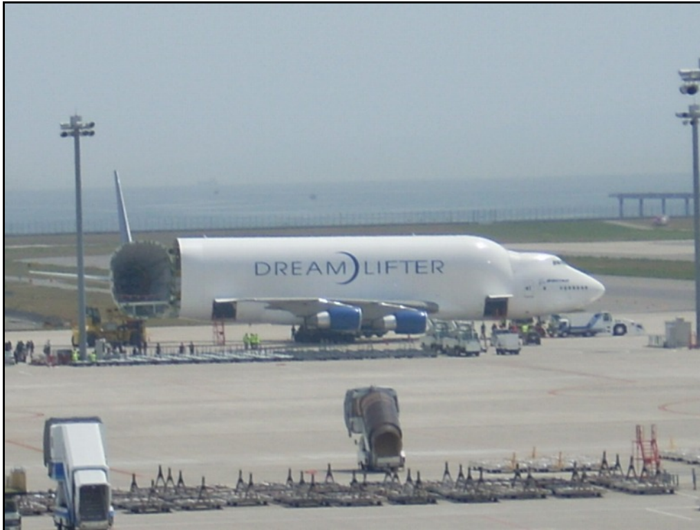
Σχήμα 3.36 B747LCF με ανοιχτή τη θύρα φόρτωσης (ουρά αεροσκάφους)
