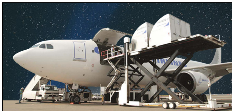
Σχήμα 3.81 Φόρτωση ULD AAX από την μπροστινή πάνω θύρα σε A300F
