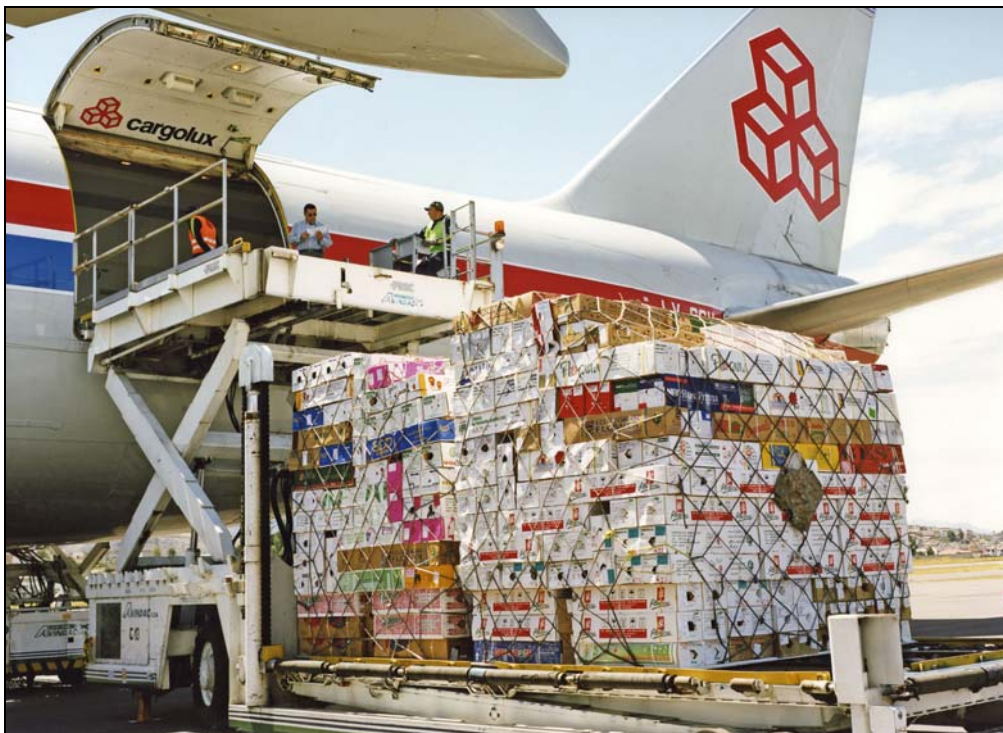
Σχήμα 3.78 Παλέτα με δίκτυ έτοιμη να φορτωθεί σε μεταφορικό αεροσκάφος
