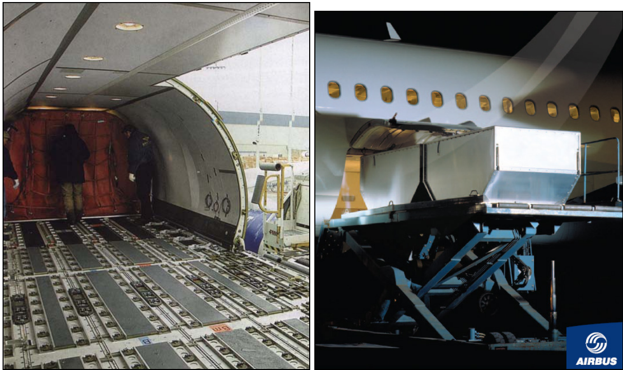
Σχήμα 3.74 & 3.75 Κύριο κατάστρωμα φόρτωσης με ράουλα & Φόρτωση ULD containers στο lower deck από την πλευρική θύρα με χρήση high loader
