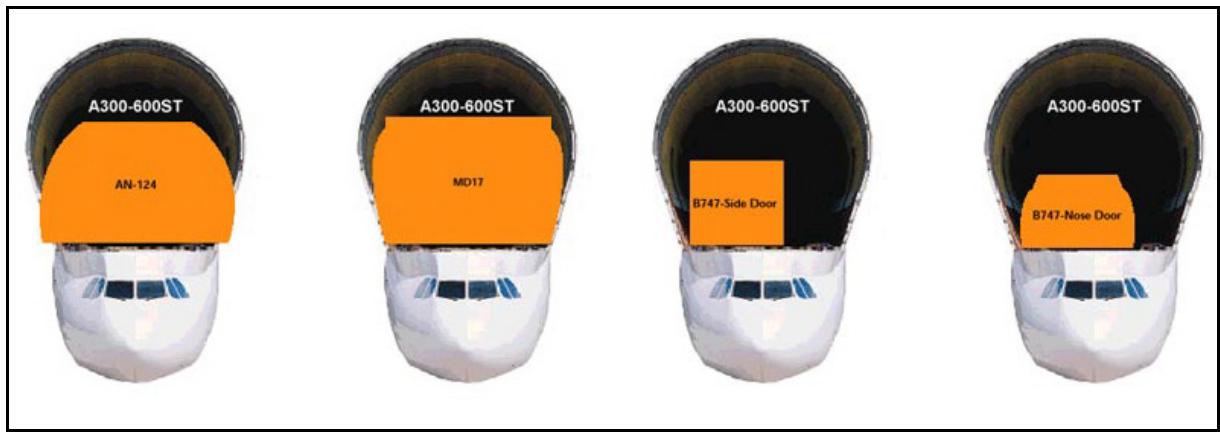
Σχήμα 3.13 Σύγκριση της διατομής ατράκτου του Beluga με άλλα μεταφορικά α/φ
