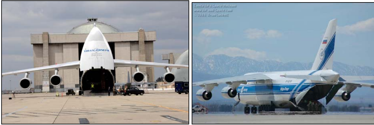
Σχήμα 3.50 & 3.51 Το ανυψούμενο ρύγχος & η ανοιγόμενη πίσω ράμπα του An-124
