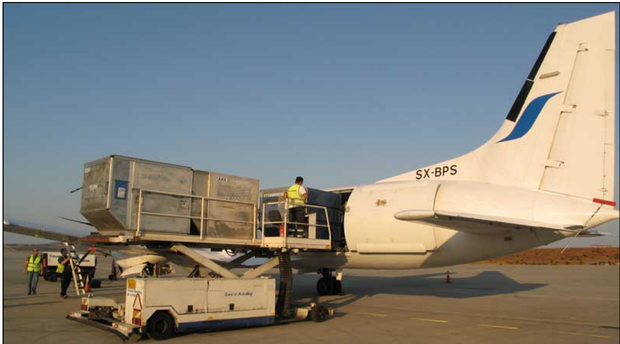
Σχήμα 5.26 Φόρτωση containers σε BAe ATP Freighter με χρήση cargo high loader
