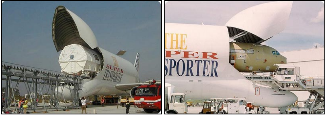
Σχήμα 3.11 & 3.12 Φόρτωση υπερμεγέθων φορτίων στο A300-600ST
