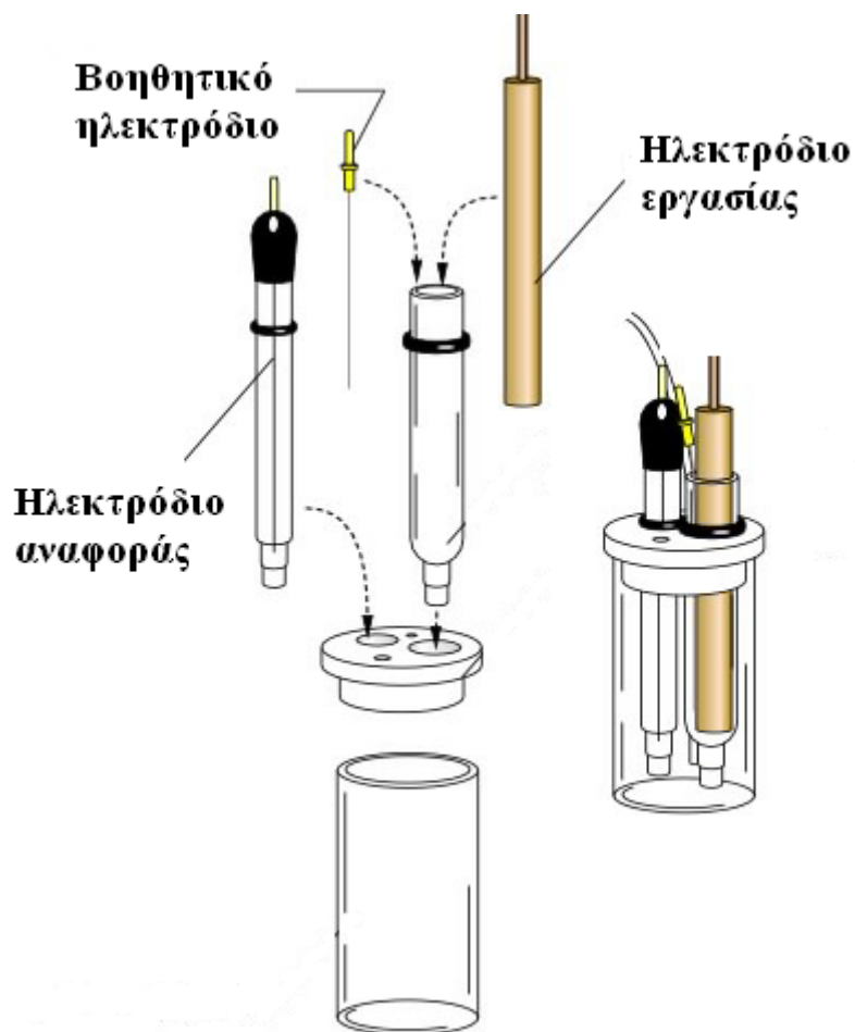
Σχήμα 8.26: Η ηλεκτροχημική κυψελίδα παρουσία των τριών ηλεκτροδίων (εργασίας, αναφοράς και βοηθητικού)
