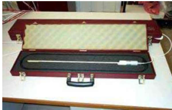
Εικόνα 7-1 : Πρότυπα θερμομέτρα αντιστάσεως λευκοχρύσου, εύρος μέτρησης: από -196 °C μέχρι 961.780 °C και αβεβαιότητα 1 - 40 mK.
