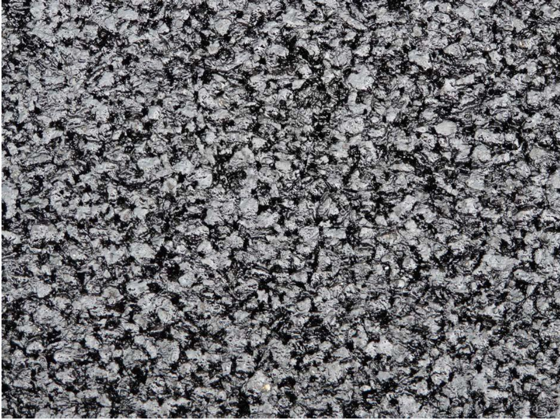
ασφαλτοτάπητας LOA 5 D πριν από κυλίνδρωση
