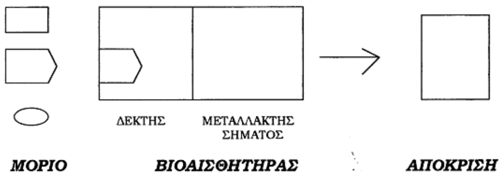
Σχήμα 3.1. Σχηματική αναπαράσταση ενός βιοαισθητήρα.
