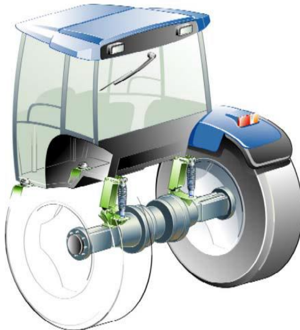
Εικόνα 4.6: Σύστημα ανάρτησης καμπίνας χειριστή "Comfort Ride" από τη New Holland.
