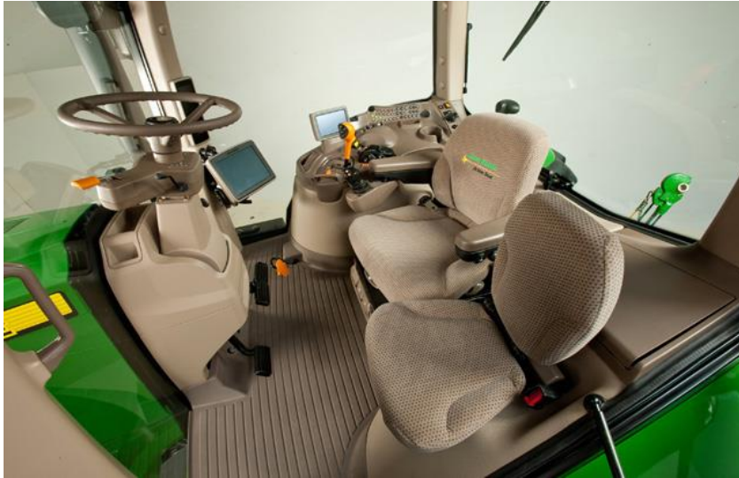
Εικόνα 4.5: Εργονομικός σχεδιασμός καμπίνας από την John Deere.
