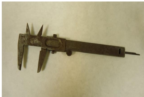
Εικόνα 2.3.3: Παχύμετρο για τη μέτρηση του επιμήκη και του εγκάρσιου άξονα του αυγού
