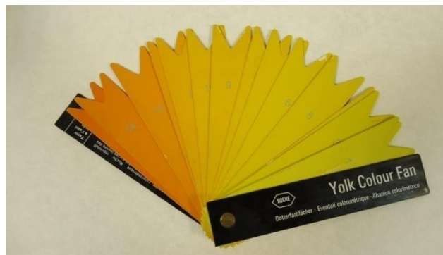
Εικόνα 2.3.5: Δεκαπενταβάθμιο ριπίδιο Roche για τον προσδιορισμό του χρώματος της λεκίθου του αυγού
