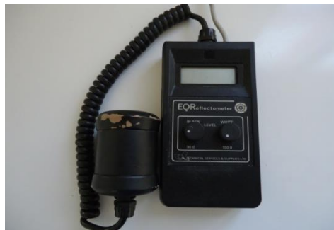
Εικόνα 2.3.6: Όργανο μέτρησης του χρωματισμού του κελύφους
