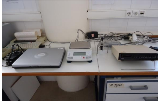
Εικόνα 2.3.8: Συσκευή υπολογισμού μονάδων Haugh
