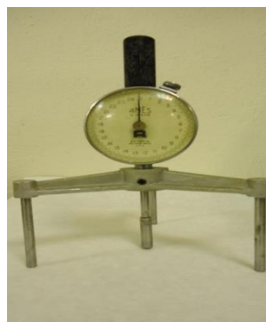
Εικόνα 2.3.4: Μικρομετρικός κοχλίας με τρίποδα
