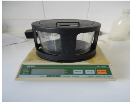
Εικόνα 2.3.2: Συσκευή προσδιορισμού ειδικού βάρους αυγού
