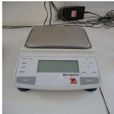
Εικόνα 2.3.1: Ζυγός ακριβείας για τη μέτρηση του βάρους του αυγού
