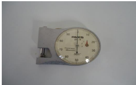
Εικόνα 2.3.7: Παχύμετρο για τη μέτρηση του πάχους του κελύφους
