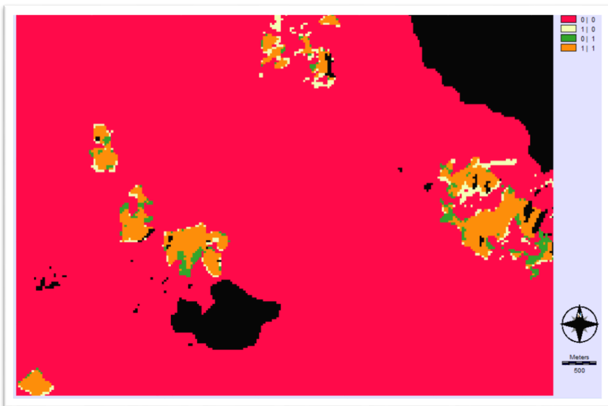
Εικόνα 67: Χάρτης εκτίμησης ακρίβειας για τα λατομεία στο αποτέλεσμα των σημαντικών στατιστικών αλλαγών με το τεστ Mann Kendall.
