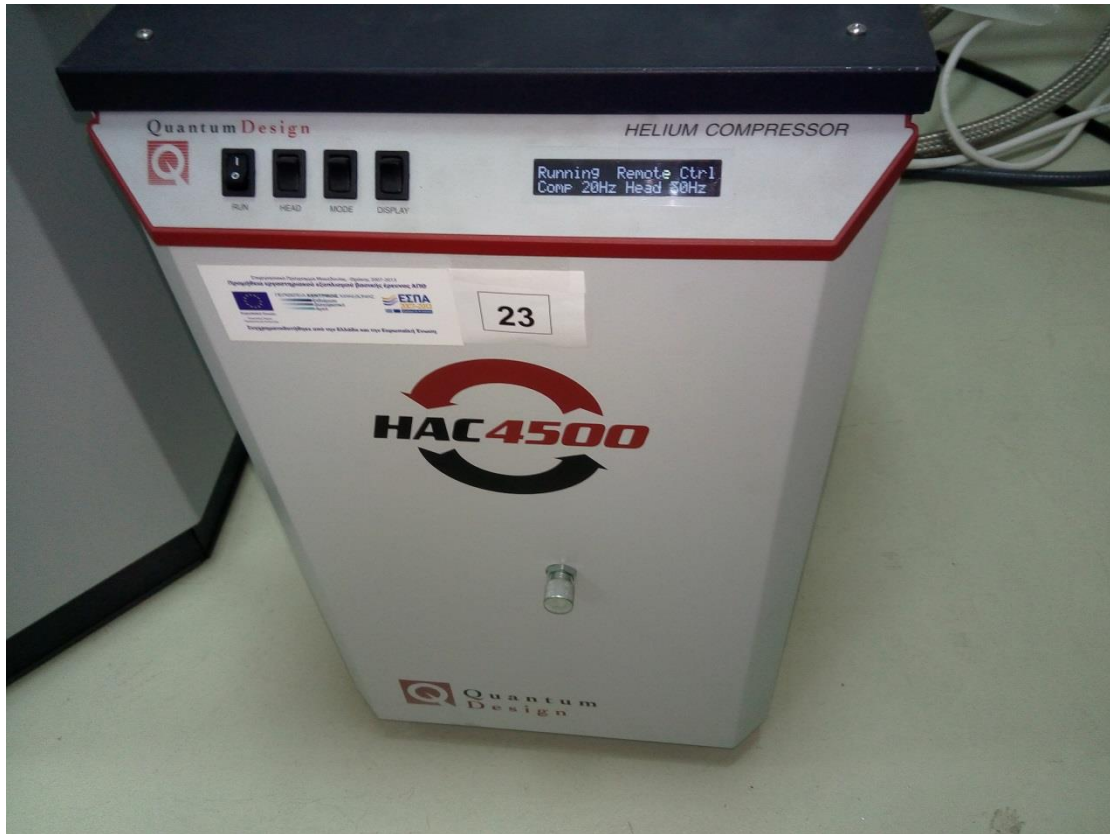
Εικόνα 5.3 - Ο συμπιεστής της διάταξης PPMS Evercool II του εργαστηρίου Ηλεκτροτεχνικών Υλικών του Α.Π.Θ
