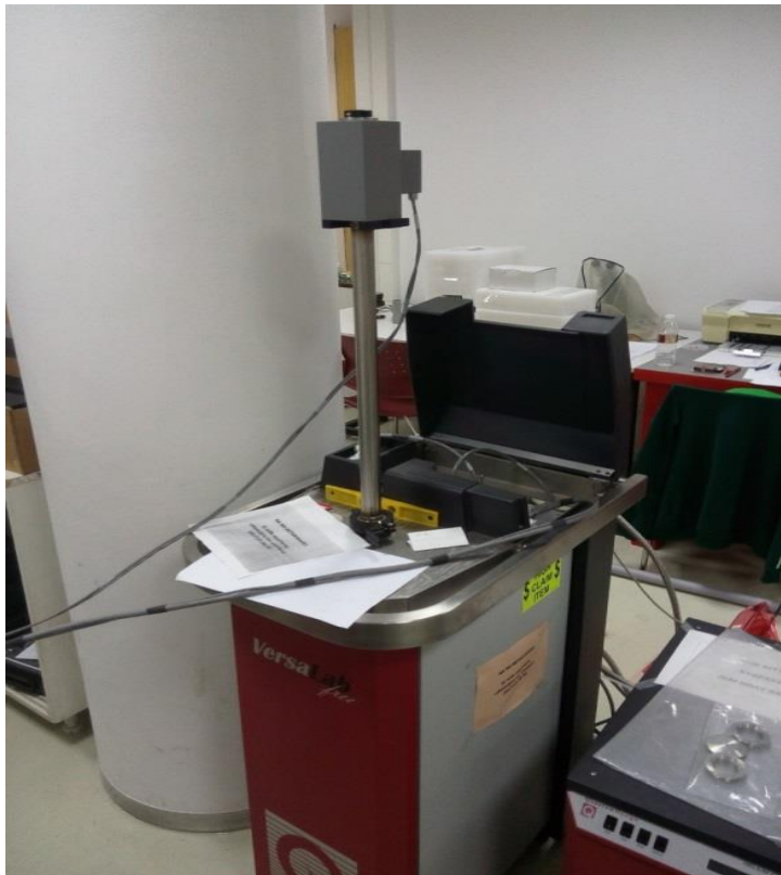
Εικόνα 5.26 – Το σύστημα PPMS VersaLab με τις τελικές του συνδέσεις
