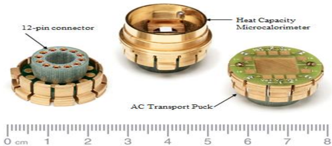
Εικόνα 5.8 - Το βύσμα δώδεκα συνδέσεων που συνδέει τον φορέα υποδοχής ενός δείγματος
