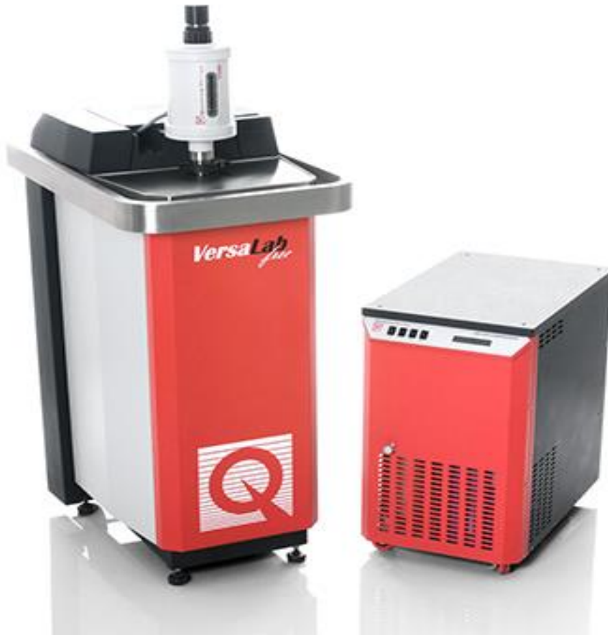
Εικόνα 5.23 -Το μαγνητόμετρο VersaLab αριστερά. Η μονάδα του συμπιεστή του δεξιά
