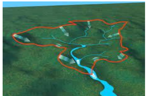
Εικόνα 2: Η χάραξη της υδροκριτικής γραμμής μιας υδρολογικής λεκάνης [3]
