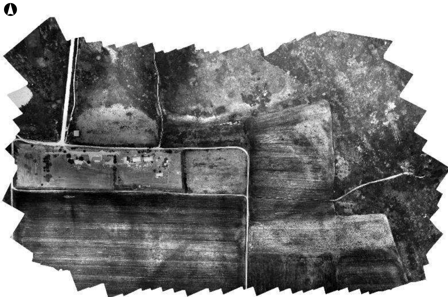
Σχήμα 7.7 Ορθοφωτομωσαϊκό Δείκτη SAVI
