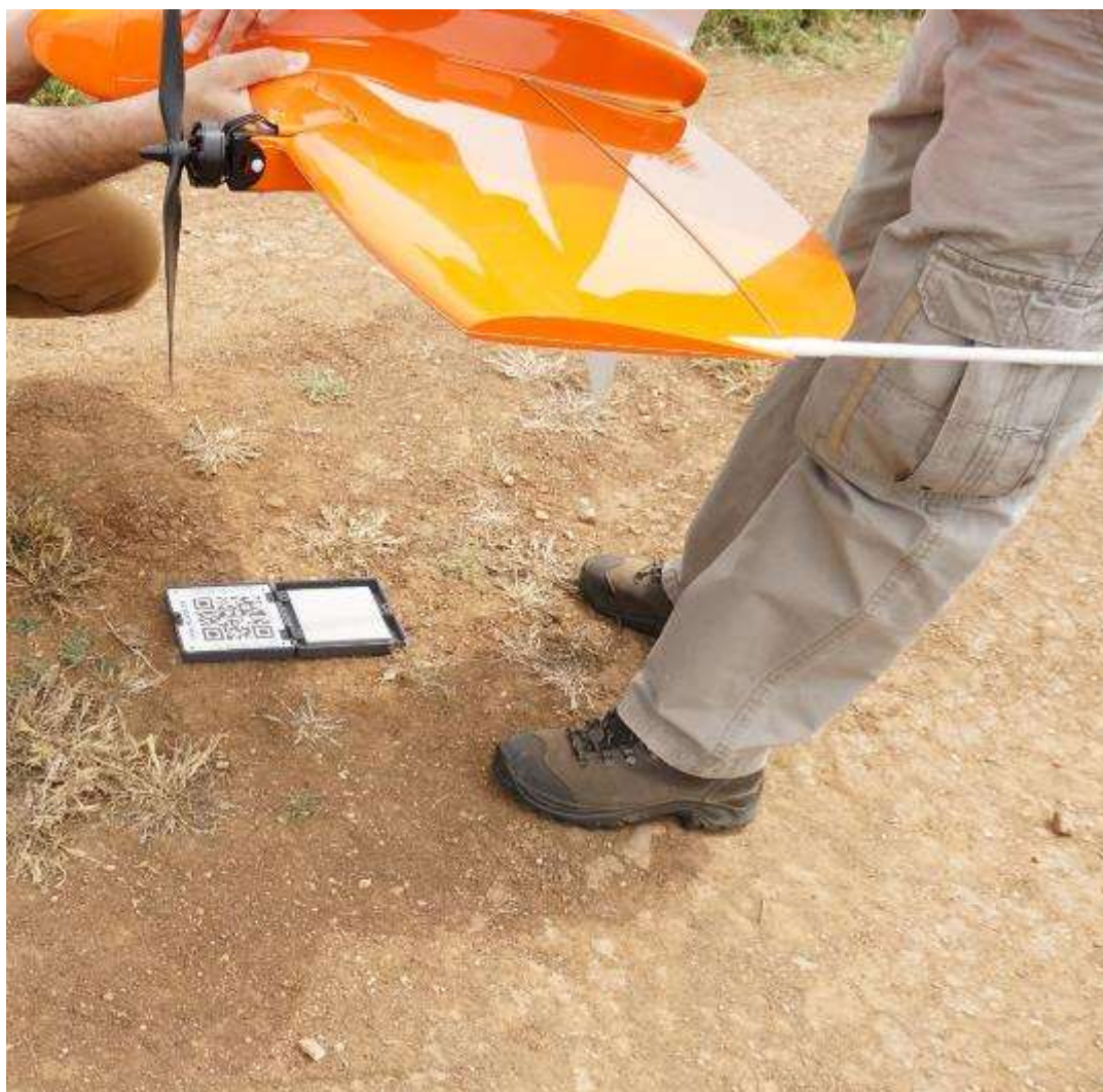
Σχήμα 2.5.2.1. Φωτογράφιση της πλακέτας βαθμονόμησης
