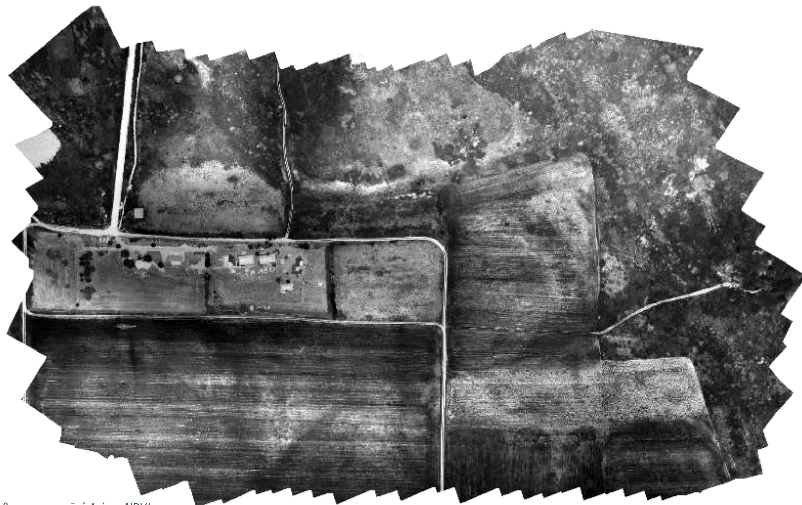
Σχήμα 7.6 Ορθοφωτομωσαϊκό Δείκτη NDVI
