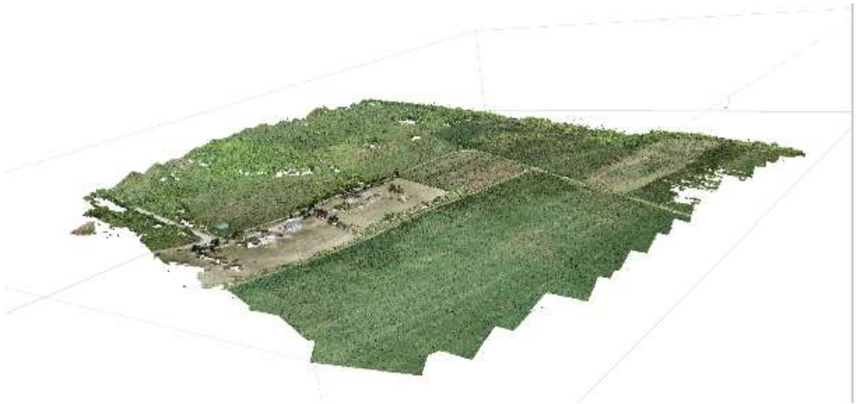
Σχήμα 2.5.1.1.9 Άποψη του dense cloud από τις πανγχρωματικές λήψεις
