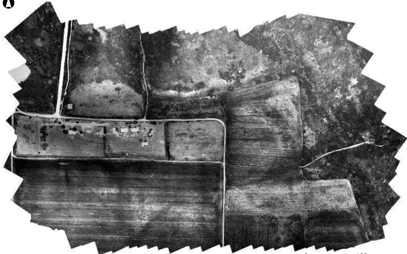
Σχήμα 7.8 Ορθοφωτομωσαϊκό Δείκτη OSAVI
