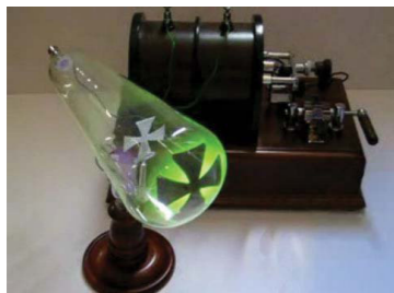
Šíření katodového záření v trubici
