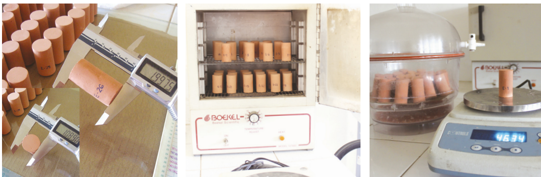
Fig. 3.48.- Medición, secado y peso de probetas. Fuente: Toma propia.
