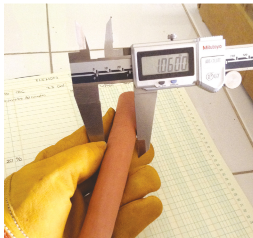
Fig. 3.42.- Medición de probetas antes de la fractura. Fuente: Toma propia.
