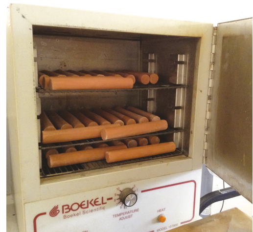
Fig. 3.43.- Secado y almacenamiento de probetas. Fuente propia.
