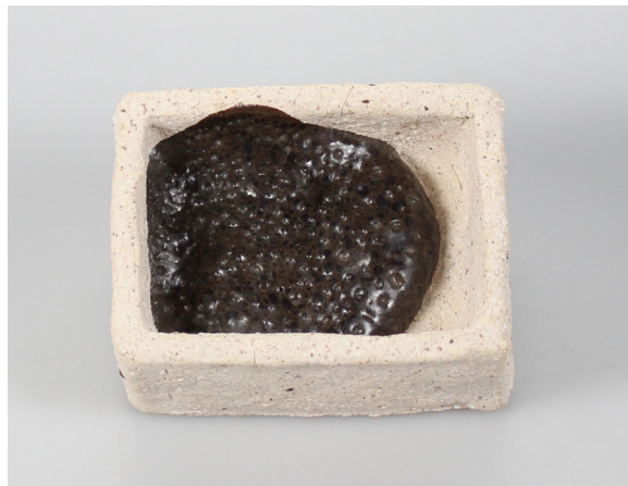
Fig. D1. - ARN-CBC en un recipiente de cerámica de alta temperatura sinterizadas a 1280°C. Fuente: Propia.
