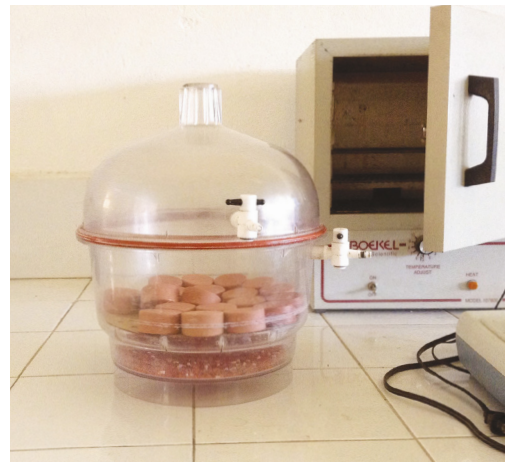
Fig. 3.36.- Enfriado de probetas en un desecador. Fuente propia.
