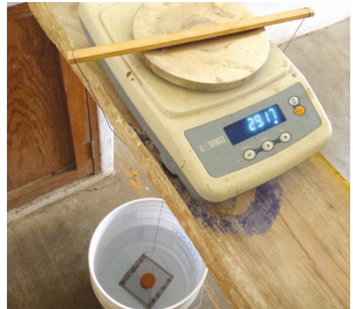
Fig. 3.39.- Tarado de la canasta suspendida y peso de la probeta. Fuente: Toma propia.
