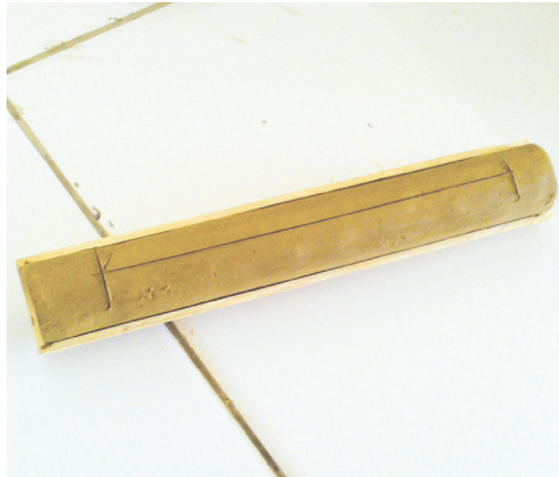
Fig. 3.29.- Línea de referencia para medir la contracción. Fuente: Toma propia.
