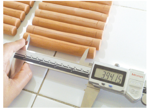
Fig. 3.34.- Medición de la contracción lineal. Fuente: Propia.
