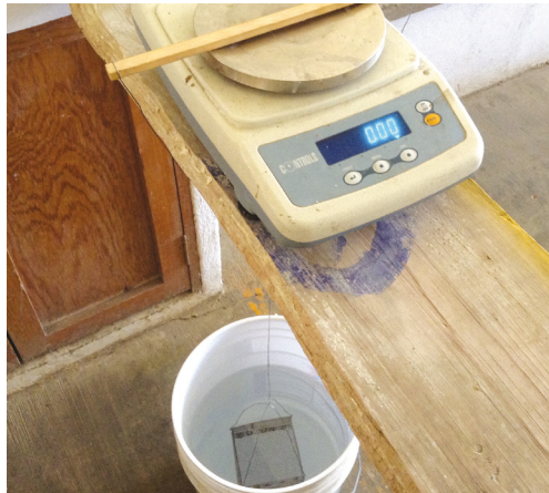
Fig. 3.39.- Tarado de la canasta suspendida y peso de la probeta. Fuente: Toma propia.
