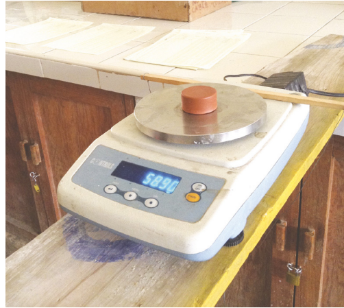
Fig. 3.41.- Determinación del peso de probetas. Fuente: Toma propia.
