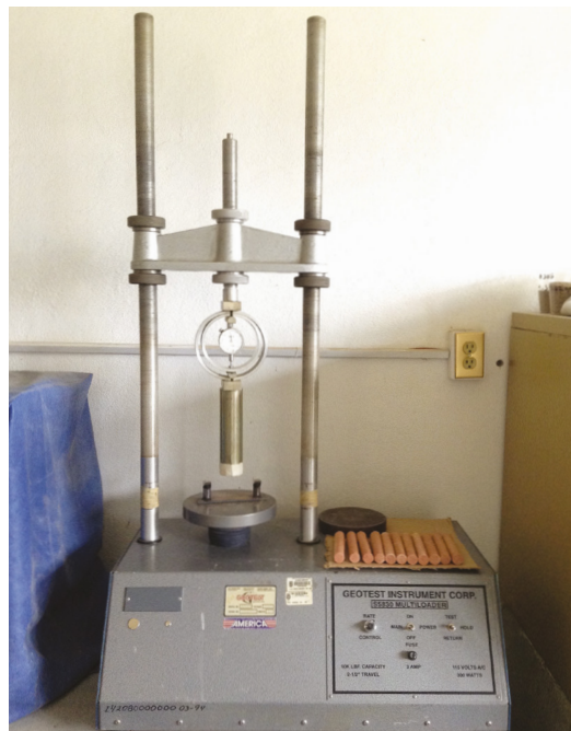
Fig. 3.45.- Prensa Hidráulica. Fuente: Toma propia.
