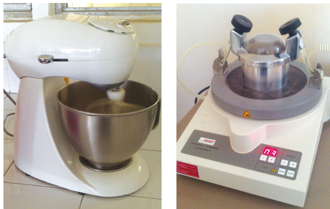
Fig.3.16.- Mezcladora Eléctrica y Pulverizadora de Bola.
