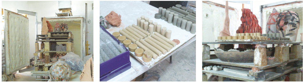
Fig. 3.26.- Horno cerámico de gas y colocacion de las probetas. Fuente: Toma Propia.
