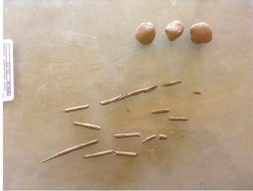
Fig. A7.- Preparación de las esferas. Fuente propia.
