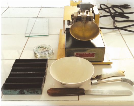
Fig. 3.12.- Equipo y accesorios para determinar Límites de atterberg. Fuente: Toma propia.
