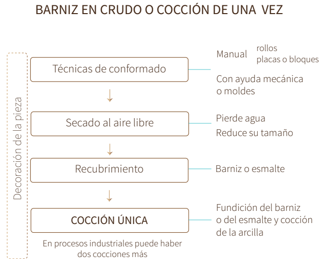
Fig. 2.3.- Proceso cerámico Barniz en Crudo o Cocción de una vez. Fuente: Birkz, 1981.
