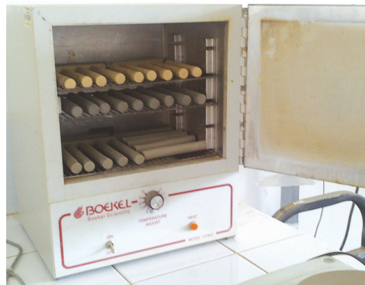
Fig. 3.31.- Secado de probetas. Fuente: Toma propia.
