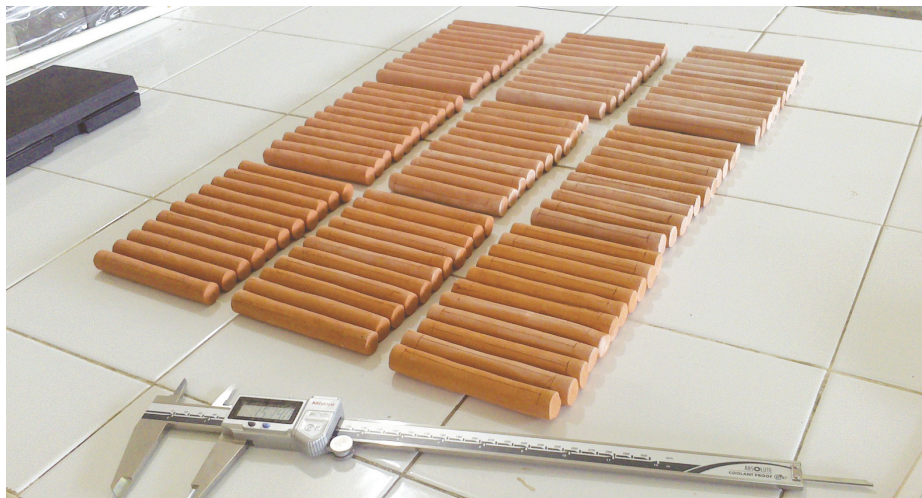
Fig. 3.33.- Los nueve compuestos después del sinterizado. Fuente: Toma propia.
