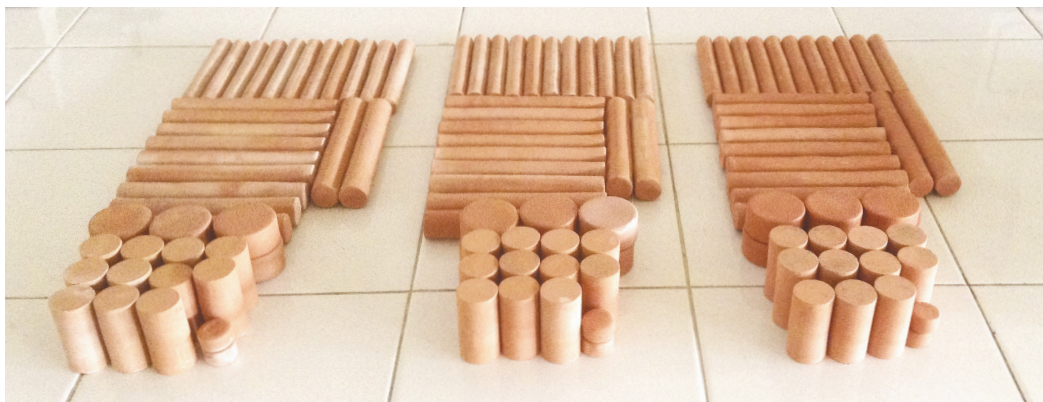
Fig. 3.28.- Probetas sinterizadas a 1080^{\circ}\text{C} . Fuente: Toma propia.
