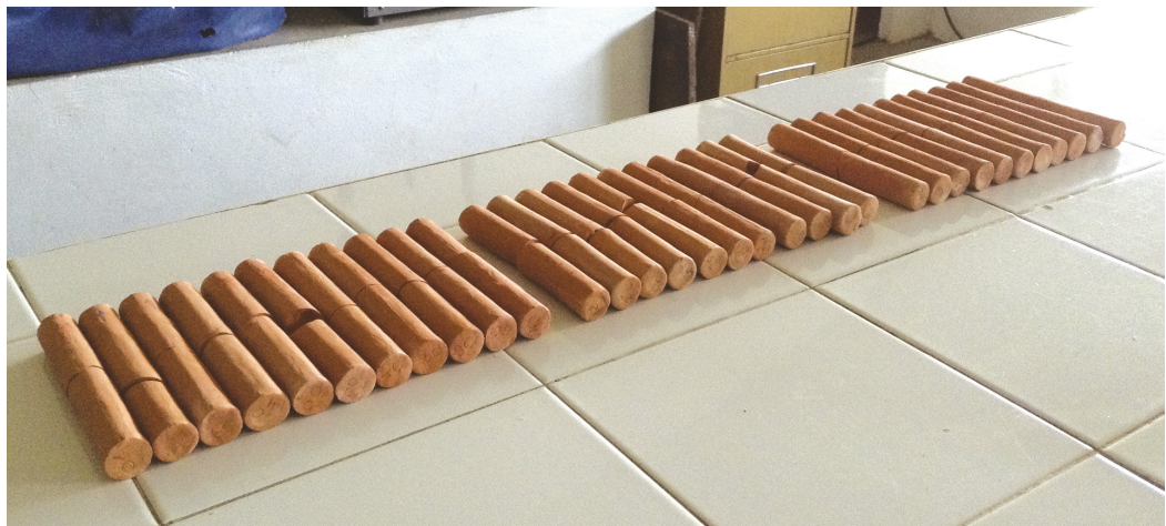
Fig. 3.47.- Probetas Sinterizadas a 1000°C fracturadas a flexión. Fuente: Toma propia.
