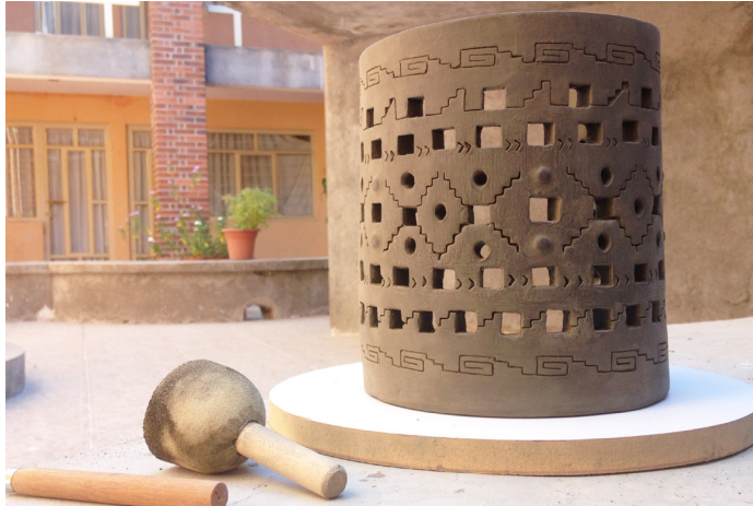
Fig. C8.- Pantalla cerámica antes del sinterizado. Fuente: Propia.
