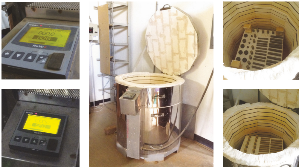
Fig. 3.25.- Horno cerámico eléctrico y colocación de probetas. Fuente: Toma propia.
