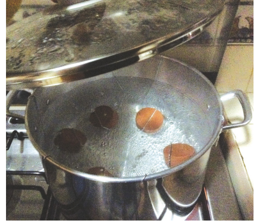
Fig. 3.38.- Probetas hervidas. Fuente: Toma propia.
