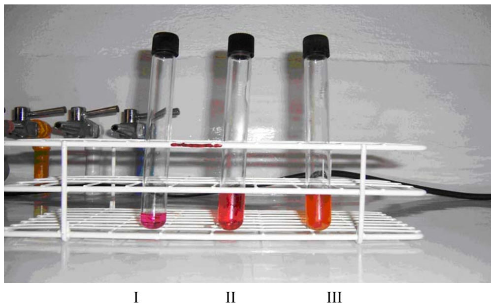
Figura 20. Fracciones colectadas por cromatografía en columna (Fracción I de color morado, Fracción II color rojo y Fracción III color amarillo).
