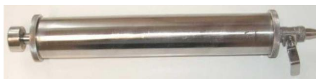
Obr. 1.8 Pipeta s pístem pro odběr plynu, délky 400 mm, nerezový materiál
