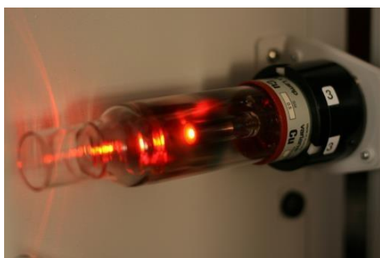
Obr. 3.13 Zdroj záření AAS (fotografie a schéma s popisem)
