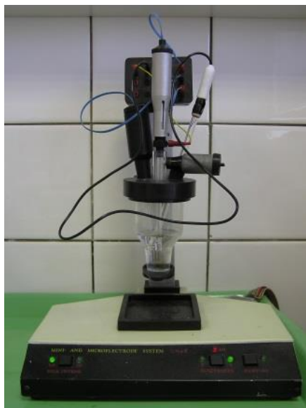
Obr. 3.17 Polarograf – třielektrodové zapojení (fotografie a schéma)
