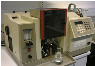
Obr. 3.12 AAS spektrometr (fotografie a schéma s popisem)
