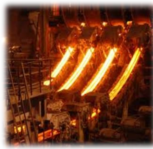
d) sekundární zóna chlazení
