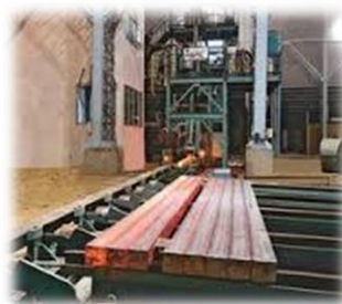
f) terciární zóna chlazení (vychlazovací lože)
