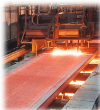
b) dělení předlitku pomocí dvou hořáků
