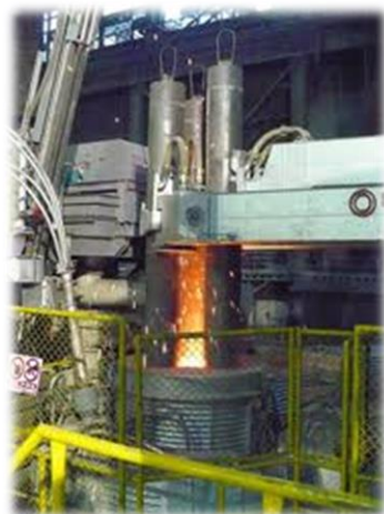
c) pánvová pec LF v provozu
