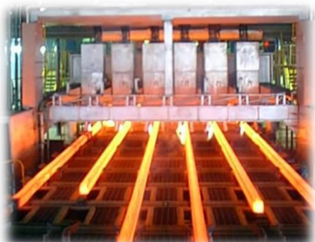
a) dělení předlitku pomocí hořáku
