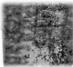
Obr. 13.14: Bodliny u čtvercového průřezu, povrch předlitku
