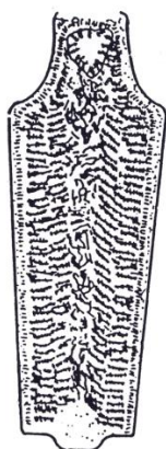
a) struktura ingotu z uklidněné oceli
