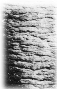
Obr. 13.7: Žebrování (tzv. „kapsa“) způsobená obtékáním tekutého kovu proti již ztuhlé vrstvě
