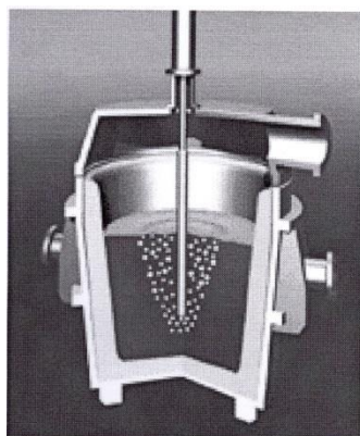
a) dmýchání inertního plynu tryskou do pánve
