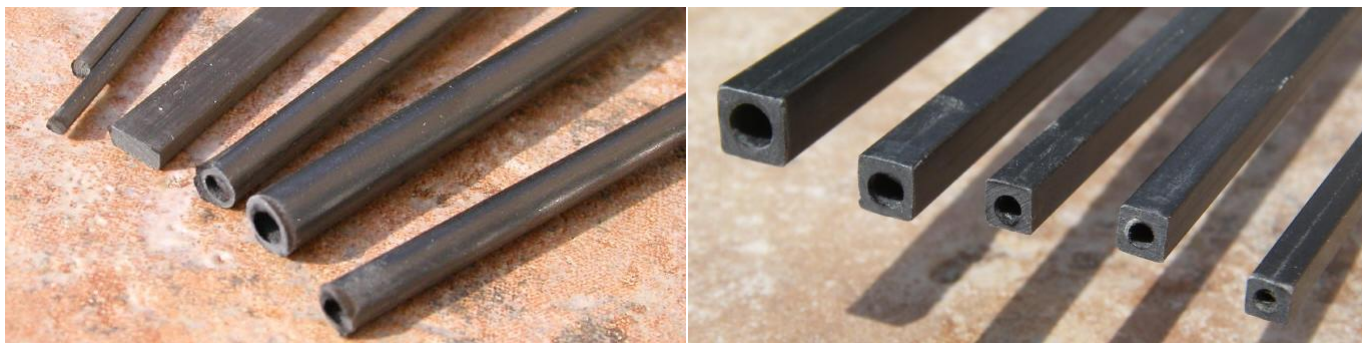
Obr. 12.4 Ukázka uhlíkových kompozitů kruhového a čtvercového průřezu s válcovou dutinou (firma Midwest).
