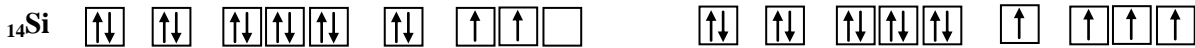
Obr. 1.2 Základní stav atomu křemíku s^2 p^2 a excitovaný stav atomu křemíku s p^3
