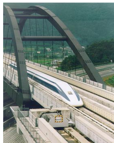
Obr. 6.7 MagLev při jízdě na testovací trati Yamanashi při rychlosti asi 200 km/hod
