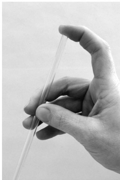
Obr. 14 - Správné držení pipet
