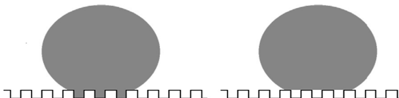
Rys. 3. Zachowanie się kropli cieczy na powierzchni niegładkiej [2]
