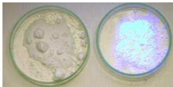
proszek do prania bez dodatku wybielacza i z wybielaczem optycznym (na prawo)
