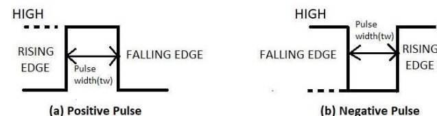
Obr. 2 Tvar impulzu digitálneho signálu
