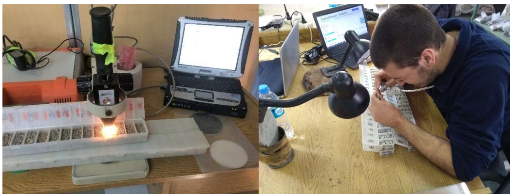
Figura 6 Izquierda: Espectrómetro portátil ASD TerraSpec. Derecha: Análisis y toma de mediciones.
