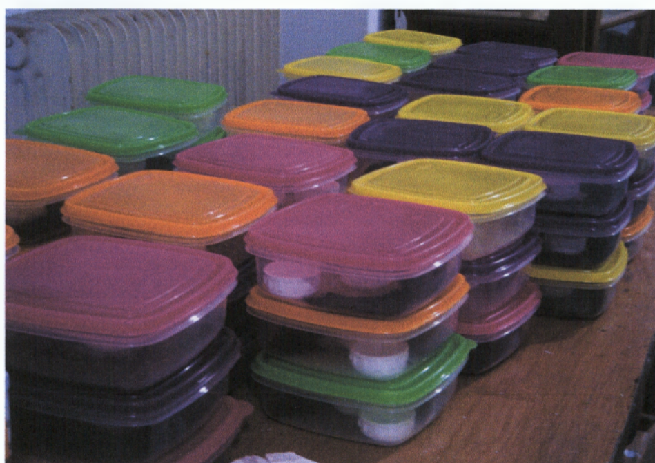
Εικόνα 6. Εγκατάσταση δοκιμής μέτρησης της μεταβολικής δραστηριότητας ( \text{CO}_2 - \text{C} ) με την χρήση παγίδας \text{NaOH} .
