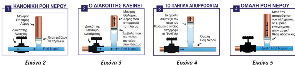
Σχήμα 6-13: Αρχή λειτουργίας υδραυλικού πλήγματος
