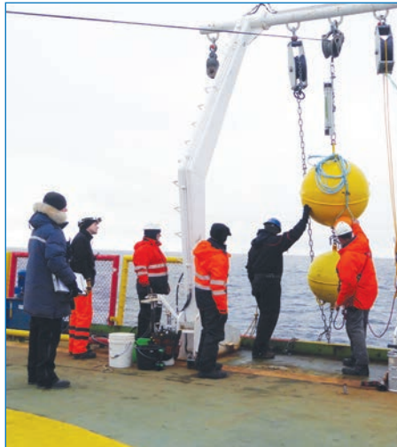
Рис. 1. Постановка долговременной заякоренной ПАБС. Фото из архивов АНИИ
