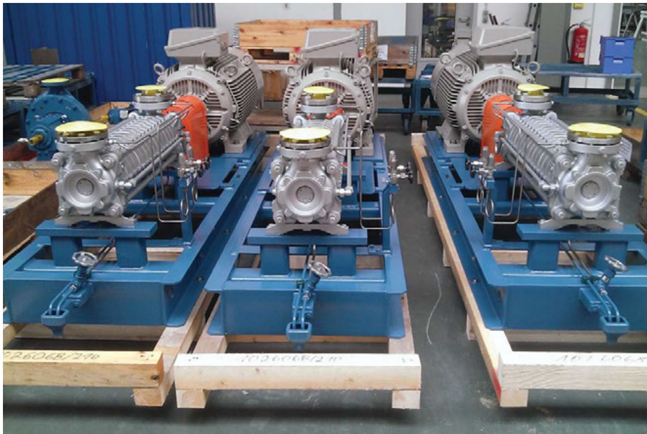
Napájecí čerpadla pro kotle teplárny v Plané
