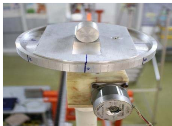
Figura 3. Sistema mecânico de rotação de fontes.
