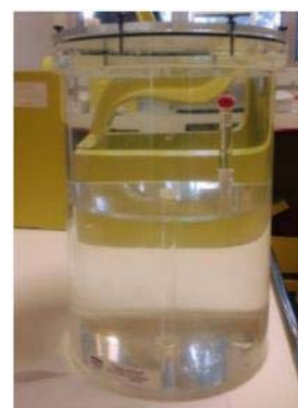
Figura 1: Simulador de acrílico contendo lesão captante (esfera vermelha);
