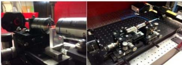
Figura 3: Arranjo para medição da intensidade e da potência da luz guiada.
