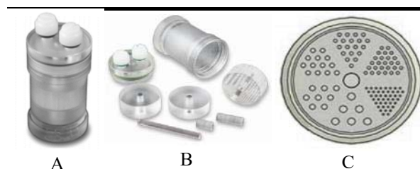
FIGURA.1. Simulador montado (A) e desmontado (B) e canais preenchíveis (C).
