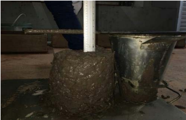
Figura 11. Slump Test do compósito
